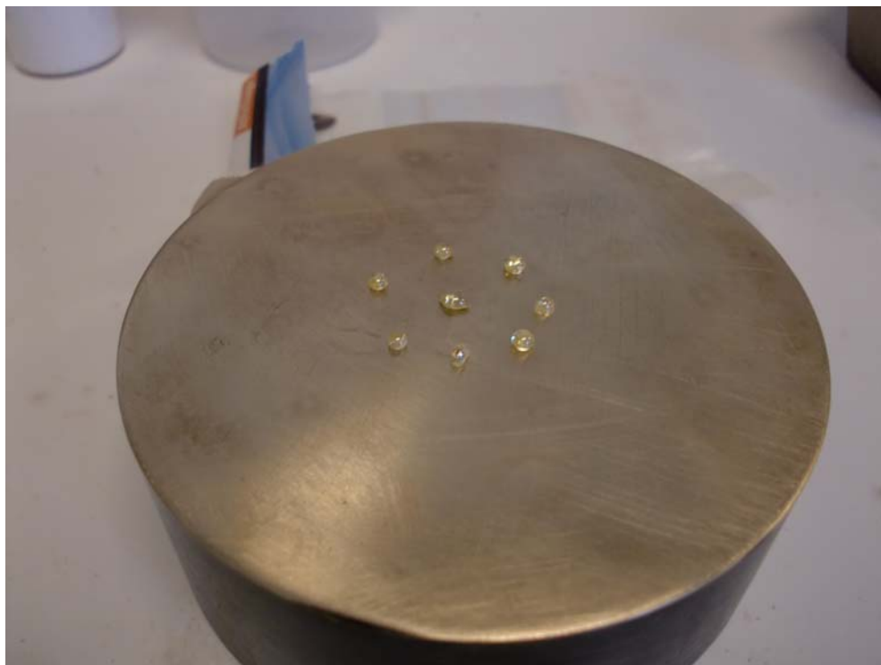
Figure 2.5 a : photo du verre 80 Sb_2O_3 10 CdCl_2 10 SrCl_2 sous forme de billes de 2-3 mm
