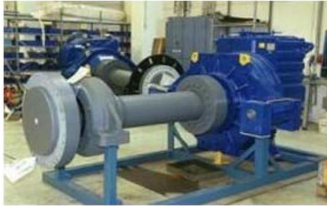
**Figure II.10 : L'arbre principal d'une éolienne [1].**
