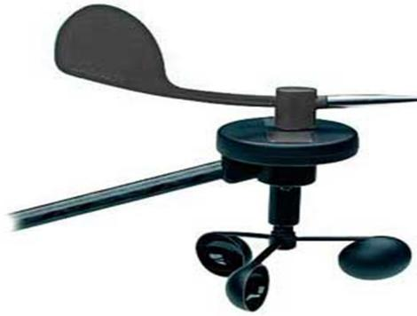
Figure II.9 : La girouette et l'anémomètre [1].
