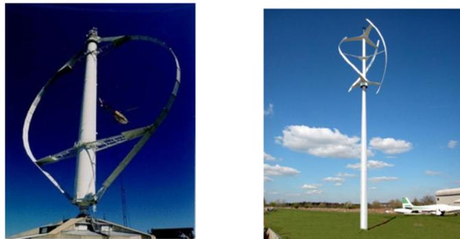
**Figure II.3: éoliennes à axe vertical de type DARRIEUS [6].**
