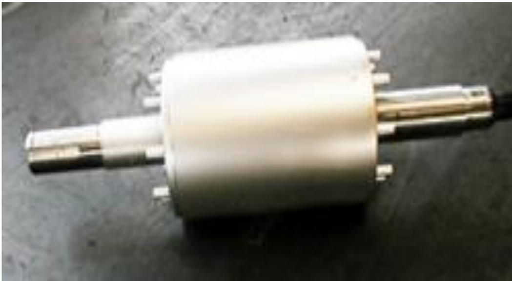
**Figure I.9.** Rotor à cage d'écurueil
