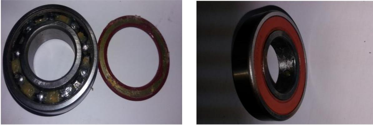
**Figure. II.3.** Photos d'un roulement défectueux dans la bague intérieure.
