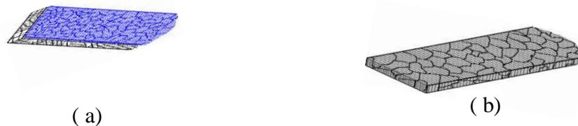
**Figure IV.3.** L'architecture des deux types de substrat, a) non orienté avec une couche superficielle texturée, b) substrat à texture biaxiale [80].
