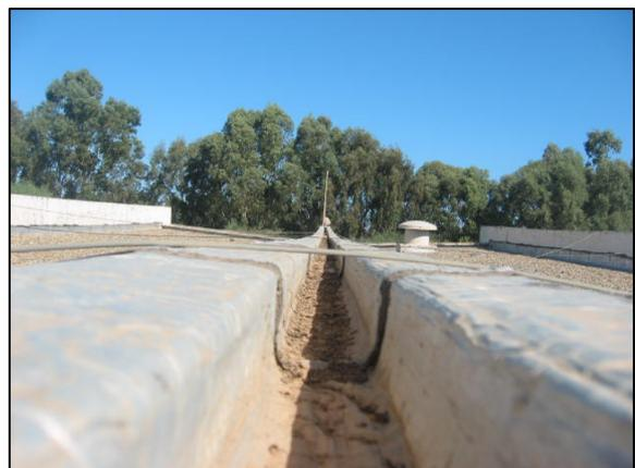
Fig. 8.6. Déformation en flexion des poutres
