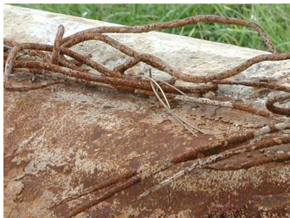
Fig. 2.1. Rupture d'une canalisation survenue suite à la carbonatation du béton [NET 01]
