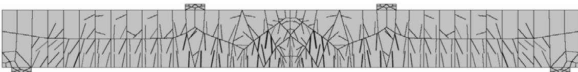
Fig. 7.21. Evolution de la fissuration d'une poutre renforcée par un lit de frp  $F=141\text{kN}$
