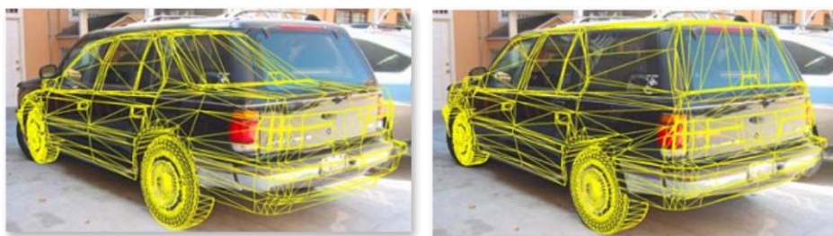
(A gauche) Un modèle de base mis sur une image réelle, (A droite) Le modèle rectifié selon les besoins,
