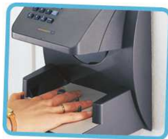
FIG4 : dispositif de reconnaissance par géométrie de la main
