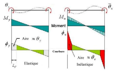
Fig. 3.3: Distribution du Moment-Courbure au niveau des zones critiques [33]
