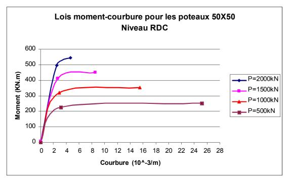
**Fig. 4.13 :** Loi moment-courbure des poteaux 50x50 du niveau RDC en fonction des différentes valeurs des efforts normaux existants
