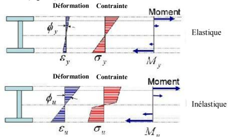
Fig. 3.1 : Comportement non-linéaire idéalisé d'un élément structurel [34]
