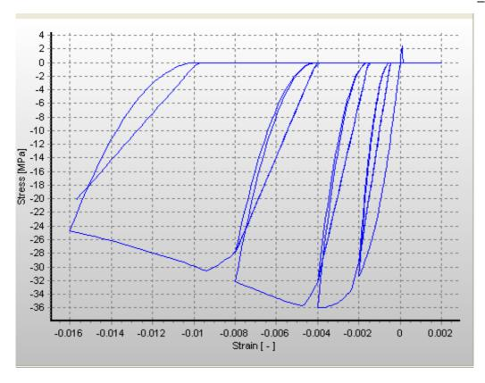
Fig. 4.4: Modèle du béton confiné constant non-linéaire con\_cc [38]
