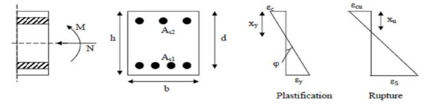
**Fig. 3.7 :** Courbure d'une section rectangulaire soumise à un moment et effort axial
