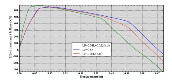
Fig 4.23 : Courbe de capacité-SeismoStruct –Poteaux 40x40
