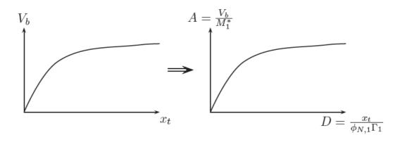
FIG. 2.8- Conversion de la courbe pushover vers la courbe de capacité [27].
