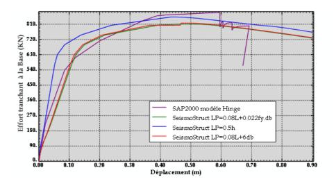
Fig4.44: Courbe de capacité- Poteaux 70x70
