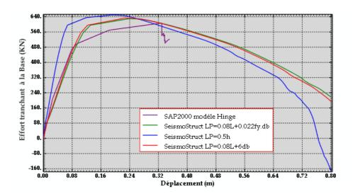
Fig4.32: Courbe de capacité- Poteaux 40x40
