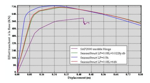
Fig4.31: Courbe de capacité- Poteaux 50x40
