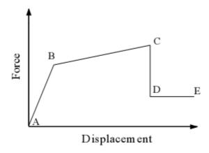
Fig. 3.10: Caractéristiques générales Force – Déplacement d'un élément [29]
