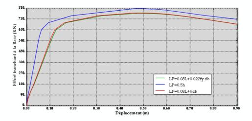
Fig4.47: Courbe de capacité-SeismoStruct -Poteaux 70x70
