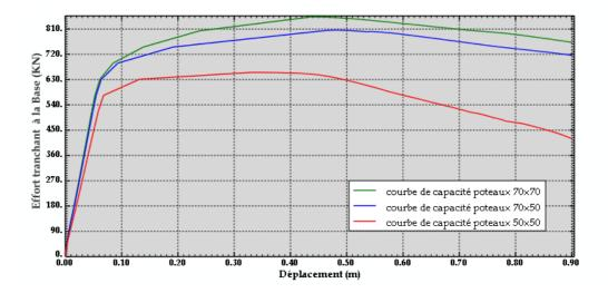
Fig4.40 : Courbe de capacité-SeismoStruct - LP=0.5h
