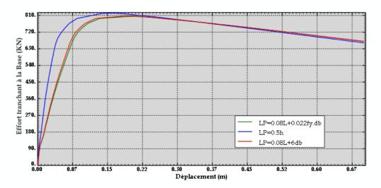
Fig 4.24 : Courbe de capacité-SeismoStruct -Poteaux 50x40
