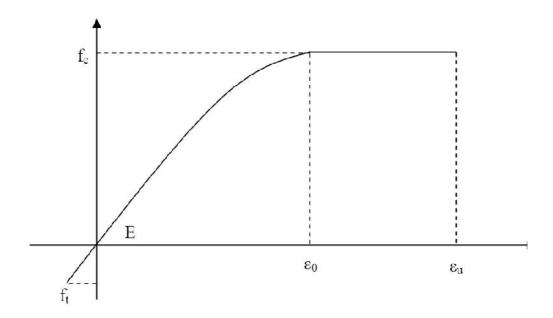
Fig. 4.1: Loi de comportement du béton [33]
