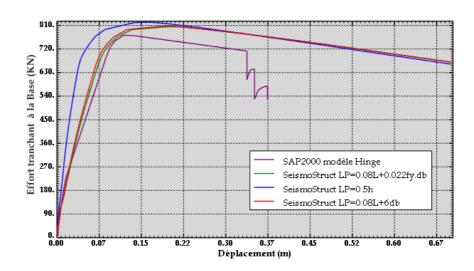
Fig 4.22: Courbe de capacité -Poteaux 50X40
