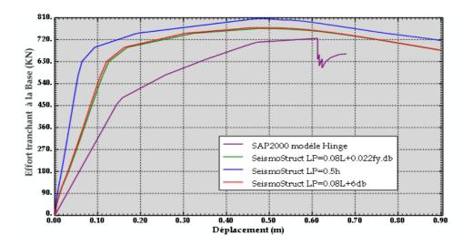
Fig4.43: Courbe de capacité- Poteaux 70x50
