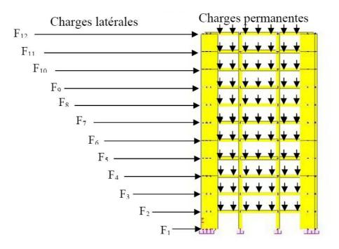
Fig. 4.9-Modèle de distribution des charges
