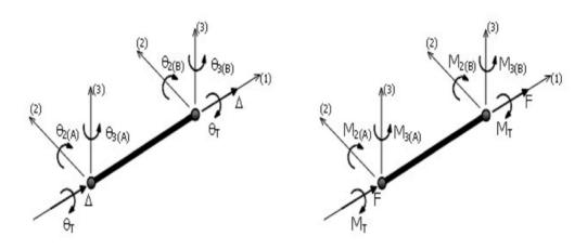
Fig. 3.8 : Système local de membrure [SeismoStruct, 2011]
