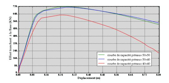
Fig4.28 : Courbe de capacité -SeismoStruct -Lp=0.08L+0.022FY.db
