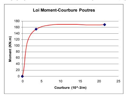
Fig. 4.11: Loi moment-courbure des poutres
