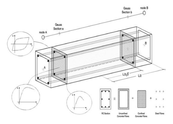
Fig. 3.9: Modèle de l'élément fibre model [SeismoStruct, 2011] [29]
