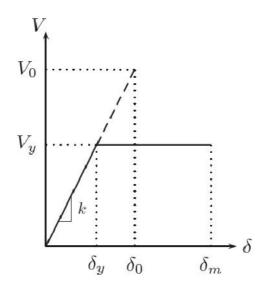
FIG. 2.3- Système linéaire correspondant au système inélastique [27]
