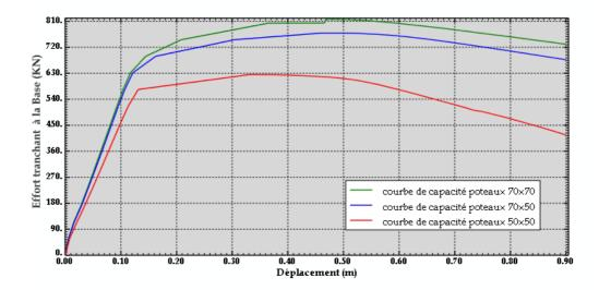
Fig4.41 : Courbe de capacité-SeismoStruct -LP=0.08L+6db
