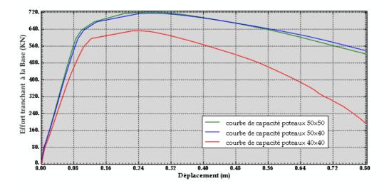
Fig4.30 : Courbe de capacité-SeismoStruct -LP=0.08L+6db
