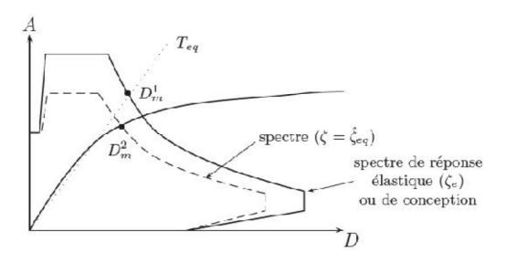
FIG. 2.11- Détermination du point de performance PP [27].
