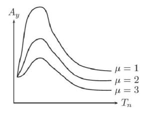
FIG. 2.4- Spectres de réponse de ductilité constante [27]
