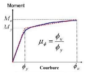
Fig. 3.2: Relation Moment-Courbure idéalisée d'un élément structurel [34]
