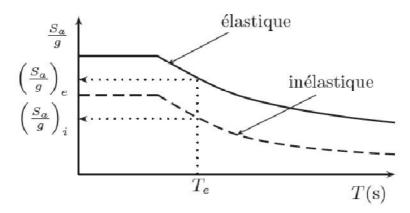
FIG. 2.1-Méthode des accélérations spectrales [27]
