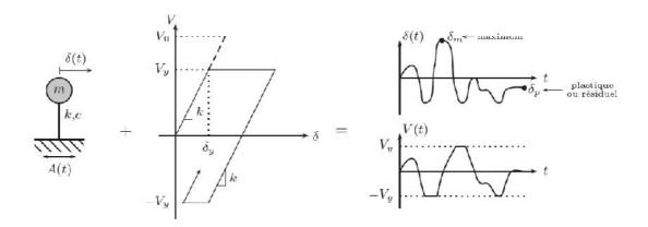
FIG. 2.2- Système d'un degré de liberté élastoplastique [27]
