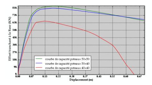
Fig 4.19 : Courbe de capacité-SeismoStruct -LP=0.08L+6db
