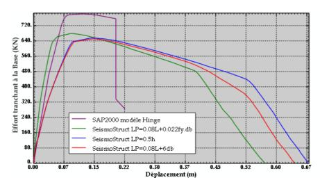
Fig 4.20 : Courbe de capacité –Poteaux 40X40
