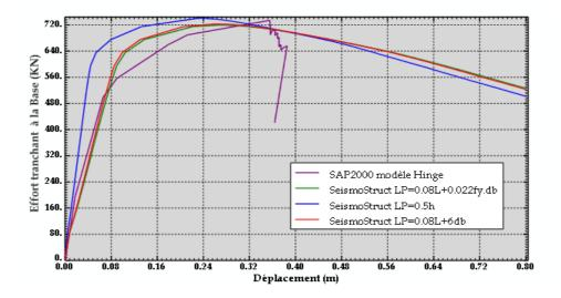
Fig4.33: Courbe de capacité- Poteaux 50x50
