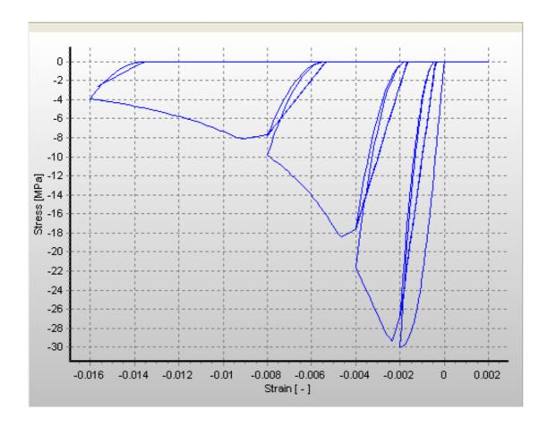
Fig. 4.5: Modèle du béton non confiné constant non-linéaire con\_cc [38]
