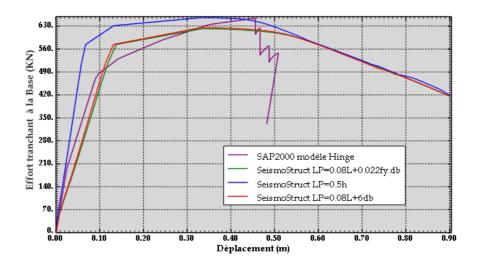
Fig4.42: Courbe de capacité- Poteaux 50x50
