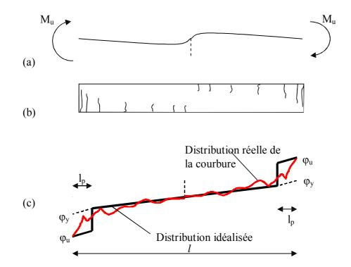
Fig. 3.5 : Distribution réelle et idéalisée de la courbure dans le domaine inélastique d'une poutre soumise à une charge sismique
