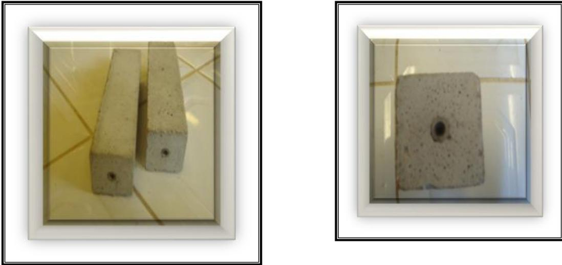
**Photo 14 :** Préparation des éprouvettes pour mesurer le retrait du BS
