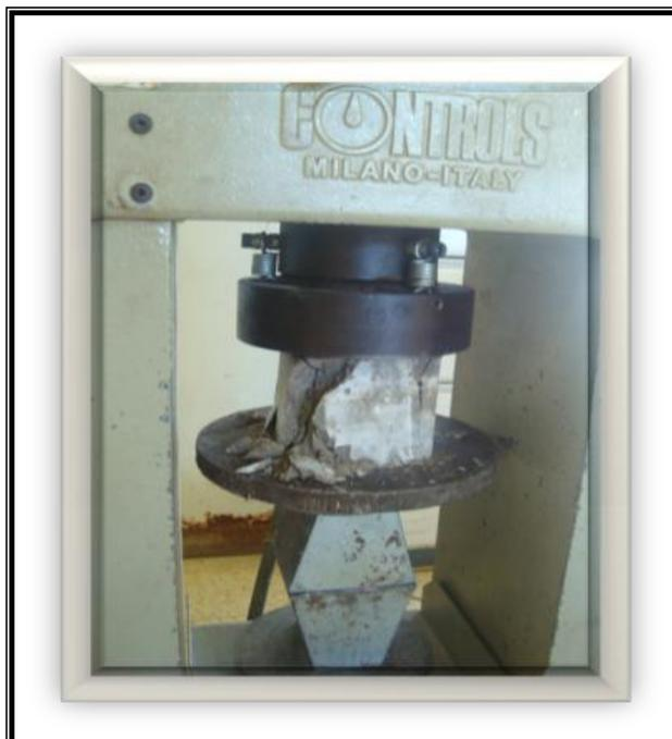
Photo 12 : Essai de compression
