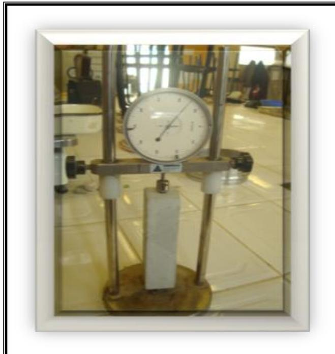
**Photo 15 :** Appareil pour la mesure du retrait
