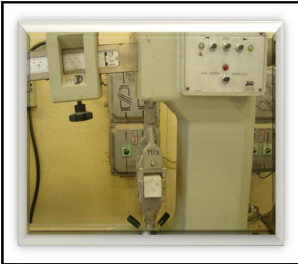
**Photo 13 :** Essai de traction par flexion
