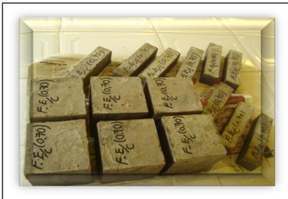
**Photo 10 :** Les éprouvettes du BS après le démoulage
