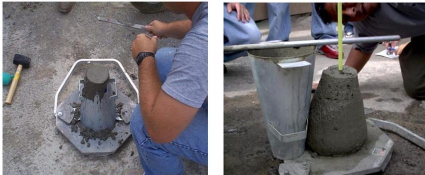
**Photo 2.5** : Essai du Slump-test.
