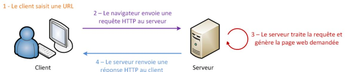
FIGURE 2.2 – Principe de fonctionnement de l'architecture Client-Serveur
