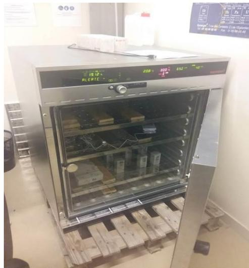
Figure 3-24 Enceinte de la carbonatation.
