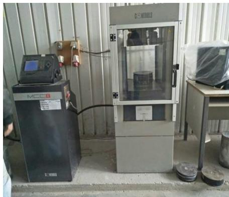
**Figure 3-9** Appareil d'essai de la résistance à la compression.
