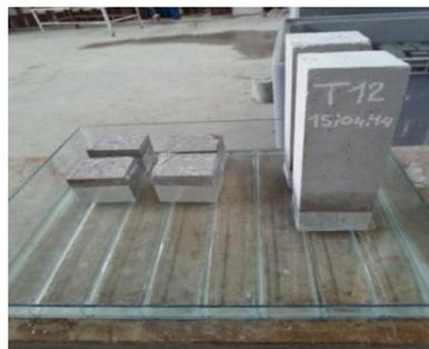
Figure 3-17 Essais d'absorption capillaire
