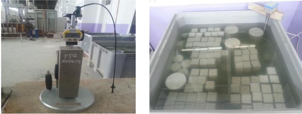
**Figure 3-12** Mesure de variation dimensionnelle.
