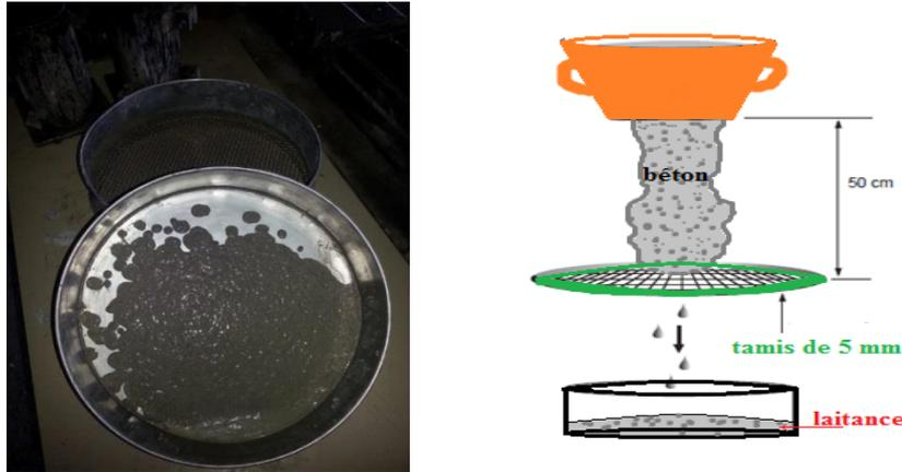
Figure 1-4 Dispositif l'essai de stabilité au tamis.
