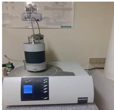
Figure 3-30 Appareil de l'analyse thermogravimétrique.
