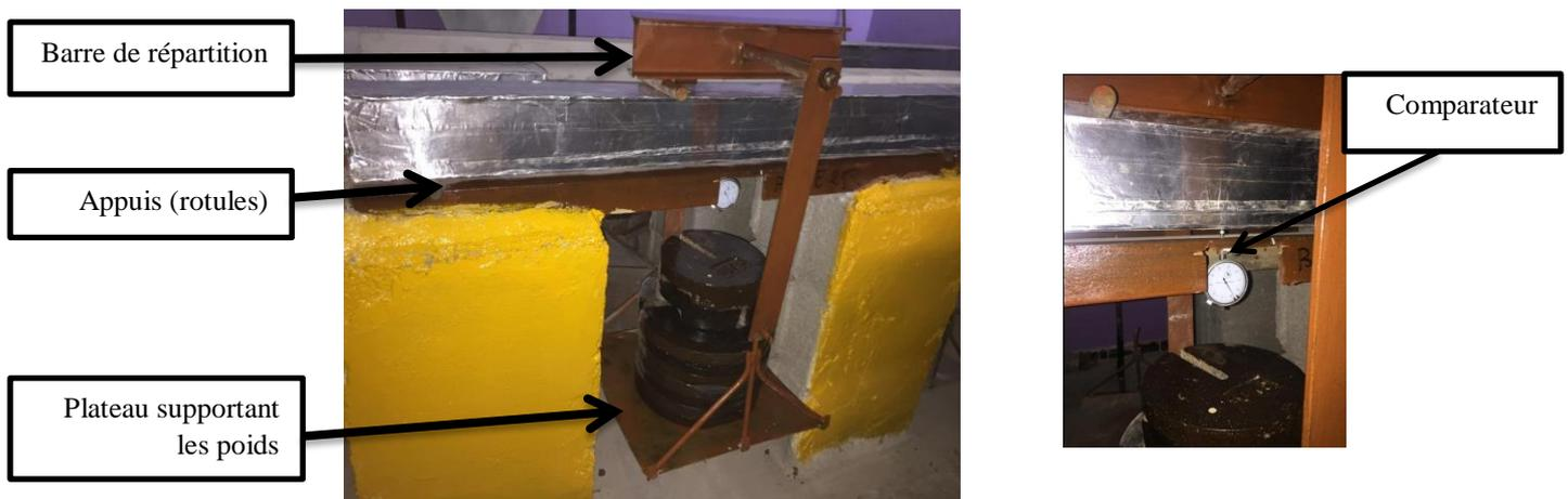
**Figure 3-13** Dispositif du fluage flexionnel (Chabane et Houari 2008)
