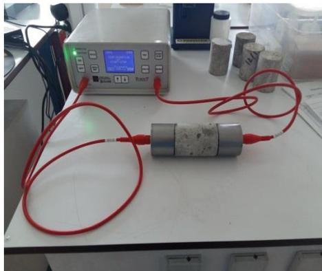
**Figure 3-23** Essai de l'ultrason.
