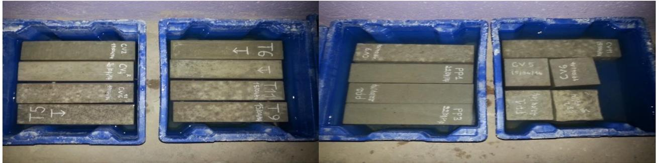
Figure 3-16 Bacs de conservation dans la solution ( $\text{Na}_2\text{SO}_4$ )
