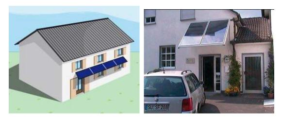
Fig. (I-III-21)- exemple d'installation des capteurs solaires en auvent d'une entrée ou brise soleil.
