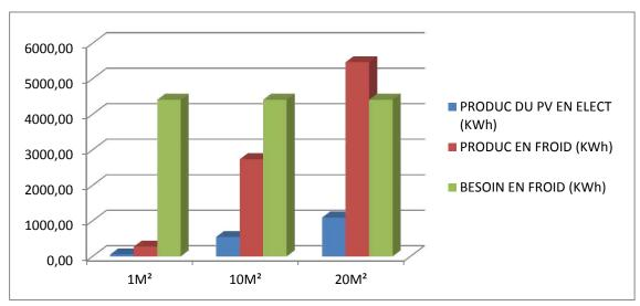
**Graphe (II-II-39)**- Balances énergétiques du Prototype 2 à Batna (KWh).
