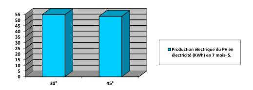
Graphe (II-II-25)- Production du capteur PV dans la région de Batna orienté au Sud (KWh).
