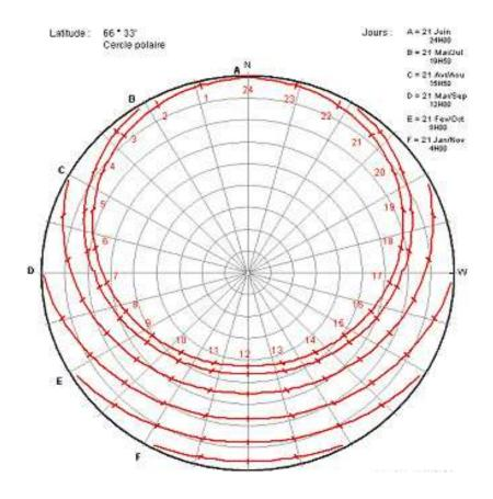
**Fig. (I-I-4)-** Diagramme solaire de la latitude 66°33 Nord (cercle polaire) : particularité au solstice d'été le soleil ne se couche pas. (Source Contrôle de l'ensoleillement et de la lumière en architecture, Marc-André VELAY-DABAT, Ecole d'architecture de Marseille-Luminy, édition 2004)
