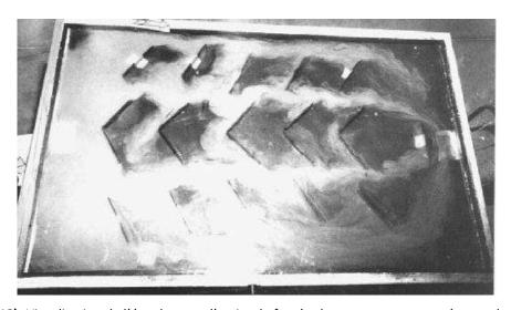
**Fig. (I-II-18)-** Visualisation de l'écoulement d'un jet de fumée dans un capteur en présence de chicanes triangulaires (source : cours de M. MOUMI Abdelhafid, énergétique 1<sup>ère</sup> année magister, 2007-2008)
