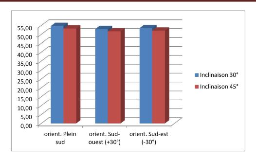
Graphe (II-II-28)- comparaison de la production électrique de 1 m² de PV à Batna (KWh).
