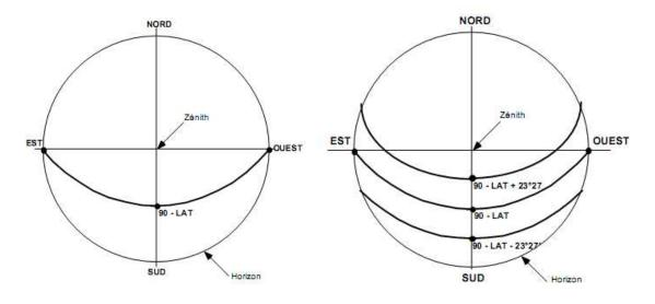
**Fig. (I-I-1)-** Diagramme solaire simplifié : course de l'équinoxe et des solstices d'une altitude LAT. (Source Contrôle de l'ensoleillement et de la lumière en architecture, Marc-André VELAY-DABAT, Ecole d'architecture de Marseille-Luminy, édition 2004)
