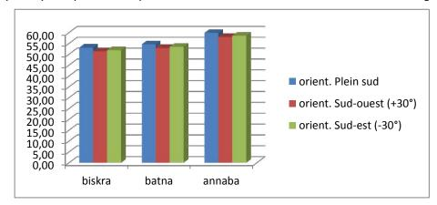
Graphe (II-II-33)- Production en électricité de 1 m² de PV incliné à 30° (KWh).
