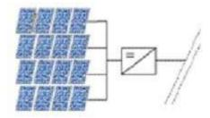
Fig. (I-II-19)- Installations non-évolutives sauf changement d'onduleur.
