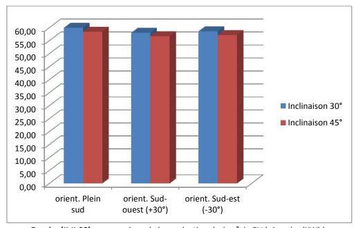
**Graphe (II-II-32)**- comparaison de la production de 1 m² de PV à Annaba (KWh).
