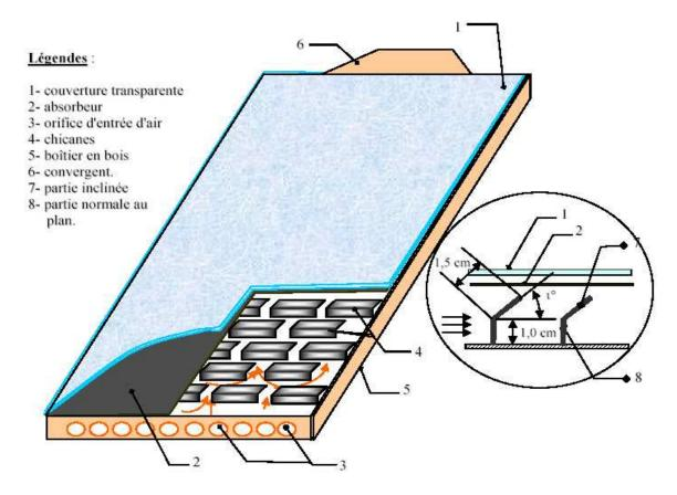
**Fig. (I-II-13)-** capteur solaire plan à air muni de chicanes. (Source : cours de M. MOUMI Abdelhafid, énergétique 1<sup>ère</sup> année magister, 2007-2008)
