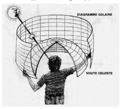
**Fig. (I-I-5)-** Projection angulaire de la course solaire. (Source Contrôle de l'ensoleillement et de la lumière en architecture, Marc-André VELAY-DABAT, Ecole d'architecture de Marseille-Luminy, édition 2004)
