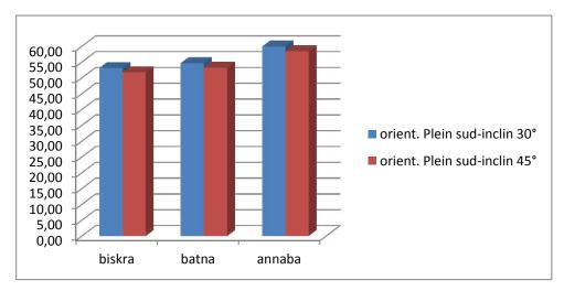
Graphe (II-II-35)- Production en électricité de 1 m² de PV dans les 3 régions (KWh).
