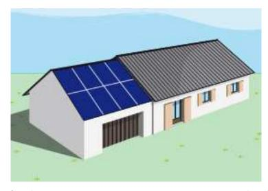
Fig. (I-III-8)- intégration du capteur sur une partie de la toiture en pente d'un bâtiment.
