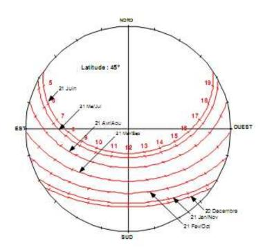
**Fig. (I-I-2)-** Diagramme solaire de la latitude 45° Nord: courses mensuelles avec indication des positions horaires. (Source Contrôle de l'ensoleillement et de la lumière en architecture, Marc-André VELAY-DABAT, Ecole d'architecture de Marseille-Luminy, édition 2004)
