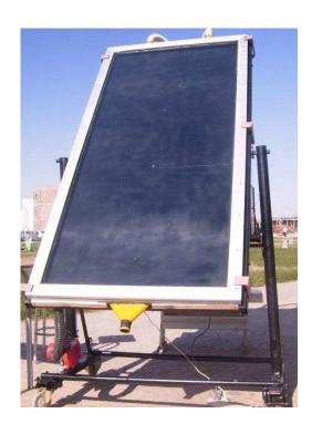
**Photo. (I-II-1)-** Capteur solaire plan à air exposé au soleil (dgm.Univ de Biskra) (source : cours de M. MOUMI Abdelhafid, énergétique 1 ère année magister, 2007-2008)
