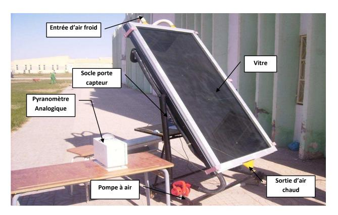
**Photo. (I-II-2)-** Capteur solaire plan à air en expérimentation (Dgm. Univ de Biskra) (source : cours de M. MOUMI Abdelhafid, énergétique 1<sup>ère</sup> année magister, 2007-2008)
