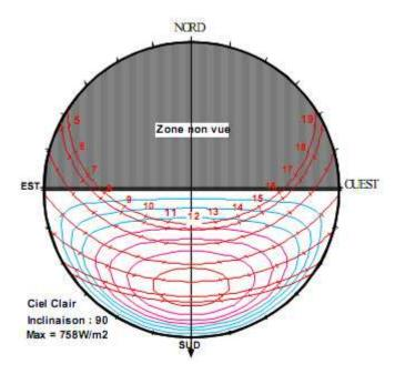
**Fig. (I-I-7)-** Eclairement énergétique du plan vertical orienté au Sud sous la latitude 45°N. (Source Contrôle de l'ensoleillement et de la lumière en architecture, Marc-André VELAY-DABAT, Ecole d'architecture de Marseille-Luminy, édition 2004)
