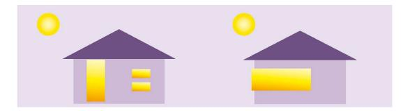
Fig. (I-III-17)- intégration des capteurs solaires sur la façade en homogénéité avec les ouvertures.
