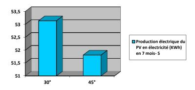
Graphe (II-II-21)- Production du capteur PV dans la région de Biskra orienté au Sud (KWh).
