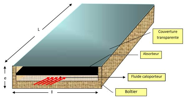
**Fig. (I-II-4)-** Schéma simplifié d'un capteur solaire plan à air (source : cours de M. MOUMI Abdelhafid, énergétique 1<sup>ère</sup> année magister, 2007-2008)
