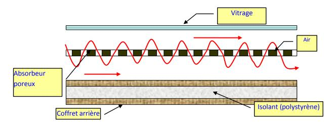
**Fig. (I-II-9)-** schéma simplifié d'un capteur à absorbeur poreux(source : cours de M. MOUMI Abdelhafid, énergétique 1 ère année magister, 2007-2008)
