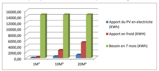
Graphe (II-II-37)- Balances énergétiques du Prototype 2 à Biskra (KWh).
