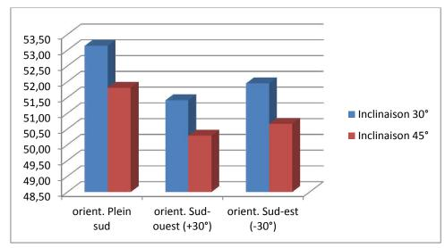
Graphe (II-II-24)- comparaison de la production de 1 m² de PV à Biskra (KWh).
