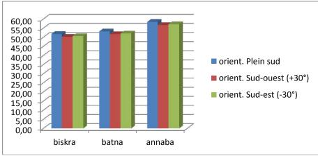
Graphe (II-II-34)- Production en électricité de 1 m² de PV incliné à 45° (KWh).
