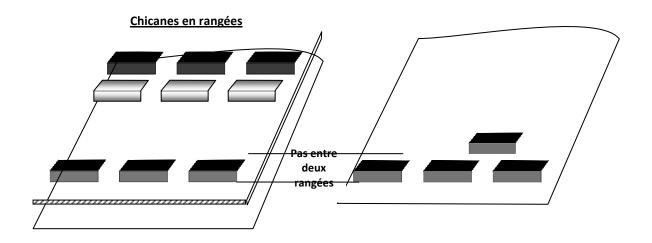
Fig. (I-II-15)- Disposition en rangée et en quinconces des chicanes dans la veine d'air mobile (source : cours de M. MOUMI Abdelhafid, énergétique 1<sup>ère</sup> année magister, 2007-2008)
