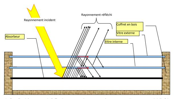
**Fig. (I-II-6)-** schématisation de l'effet de serre avec deux vitrages. (Source : cours de M. MOUMI Abdelhafid, énergétique 1<sup>ère</sup> année magister, 2007-2008)
