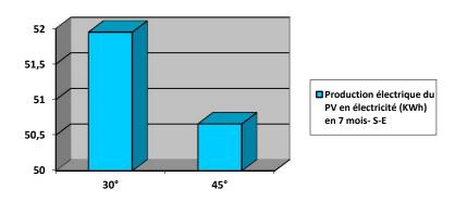
Graphe (II-II-23)- Production du capteur PV dans la région de Biskra orienté au Sud-est (KWh).
