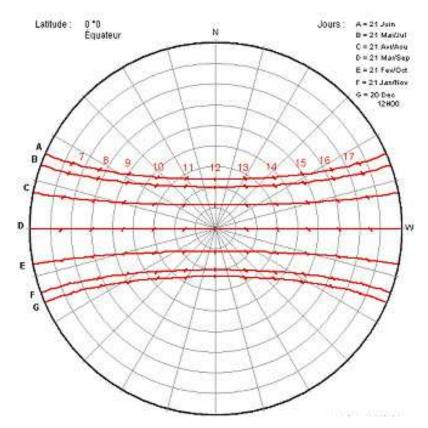
Fig. (I-I-3)- Diagramme solaire de la latitude 0 (équateur): la moitié de l'année, le soleil évolue dans le quart de sphère opposé à celui de l'autre moitié de l'année, la durée du jour est de 12h. (Source Contrôle de l'ensoleillement et de la lumière en architecture, Marc-André VELAY-DABAT, Ecole d'architecture de Marseille-Luminy, édition 2004)
