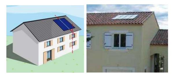
Fig. (I-III-5)- installation du capteur sur une toiture inclinée respectant l'axe de la fenêtre.
