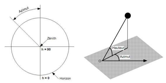
Fig. (I-I-6)- Projection sphérique : Position de l'horizon et du zénith. (Source Contrôle de l'ensoleillement et de la lumière en architecture, Marc-André VELAY-DABAT, Ecole d'architecture de Marseille-Luminy, édition 2004)
