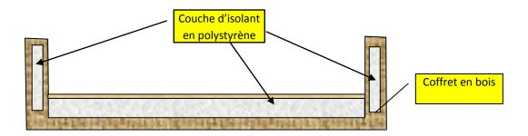
**Fig. (I-II-8)-** Isolation thermique du boîtier (source : cours de M. MOUMI Abdelhafid, énergétique 1 en magister, 2007-2008)
