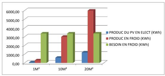
Graphe (II-II-40)- Balances énergétiques du Prototype 1 à Annaba(KWh).
