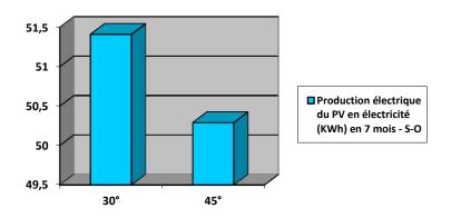
Graphe (II-II-22)- Production du capteur PV dans la région de Biskra orienté au Sud-ouest (KWh).
