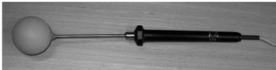
Figure. IV.23 : Thermomètre 38 mm plat globe gris. (Thorsson et al, 2007).
