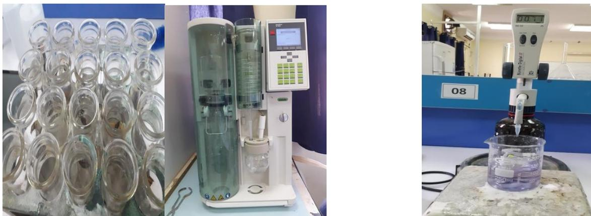
**Figure 22 :** Dosage de l'azote total (Méthode Kjeldahal) (photo original).
