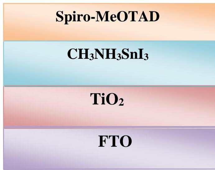
**Figure IV.1** : Structure de la cellule solaire pérovskite à base  $\text{CH}_3\text{NH}_3\text{SnI}_3$
