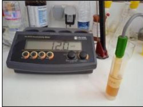
**Figure 15:** détermination de CE
