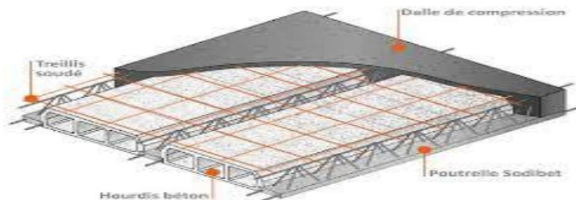
**Figure II.5.** Plancher à corps creux
