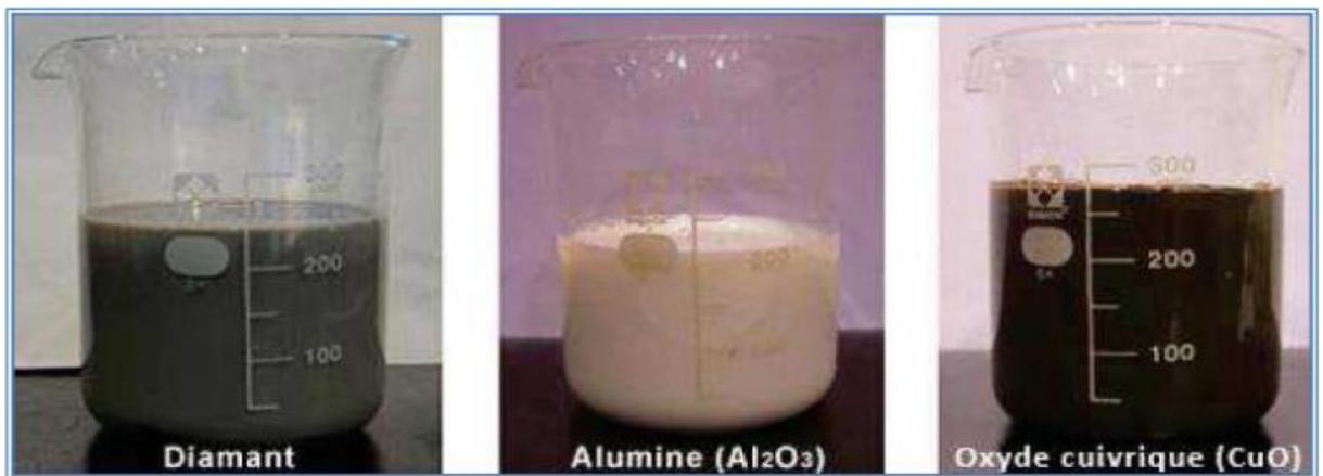
*Figure I. 6: Exemples des nano-fluides aqueux et opaques avec 1 % de nanoparticules De diverses natures [7].*
