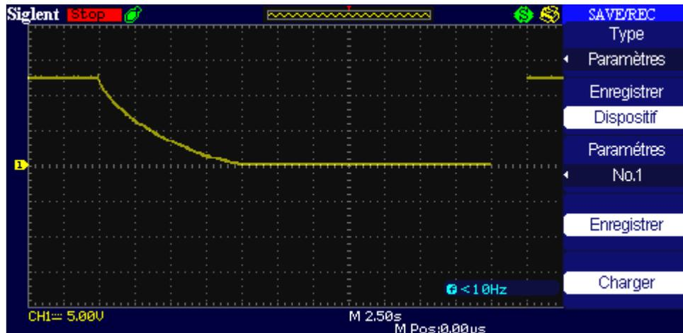
Figure II.17 L'allure de la phase transitoire de la vitesse avec l'oscilloscope.
