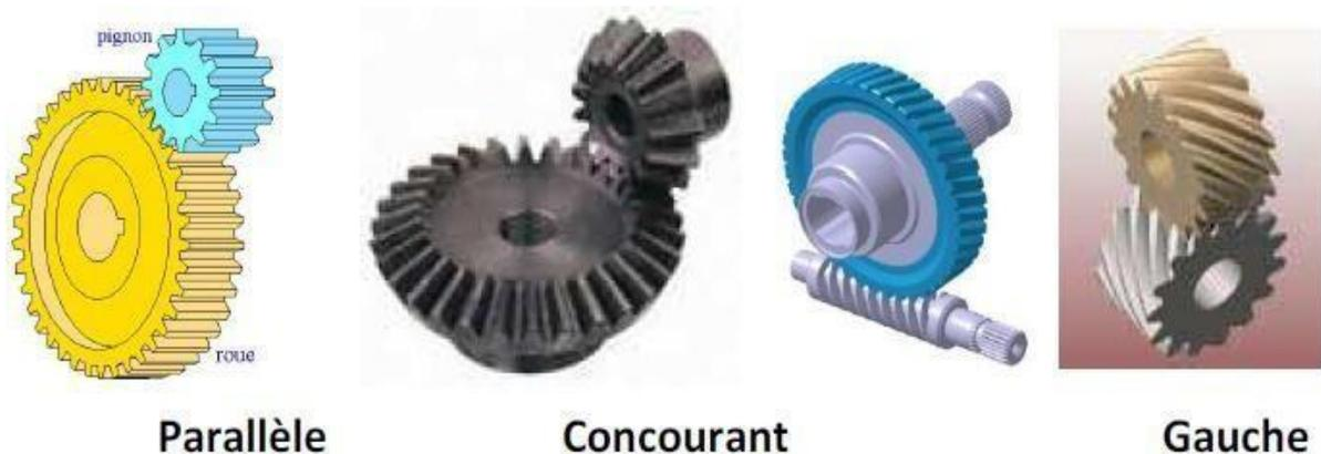
**Figure I.9.** Systèmes d'engrènement. [14]
