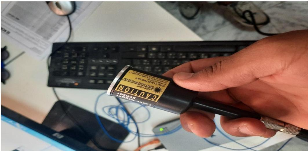
Figure II.11. Capteur de référence optique laser (Smart balancer)
