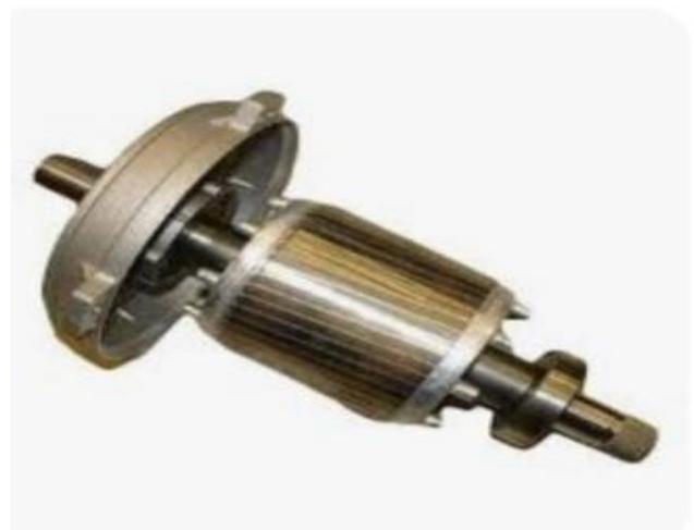
Figure. II.4. Rotor à cage d'écureuil
