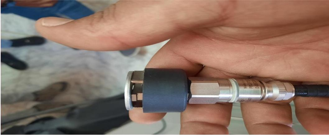
Figure II.10. Capteurs d'accélération (Smart balancer)
