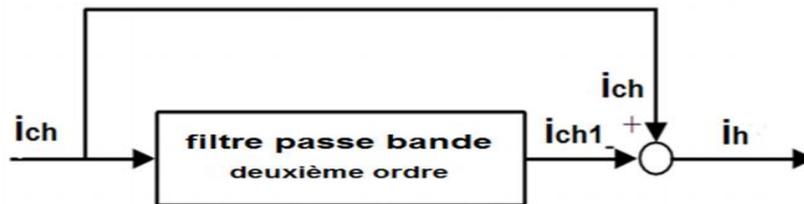
**Figure (III.28) :** Schéma représentant le principe d'identification des courants harmoniques.
