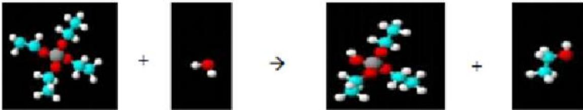
**Figure I.9 :** Schéma représentant la réaction chimique : hydrolyse [15].
