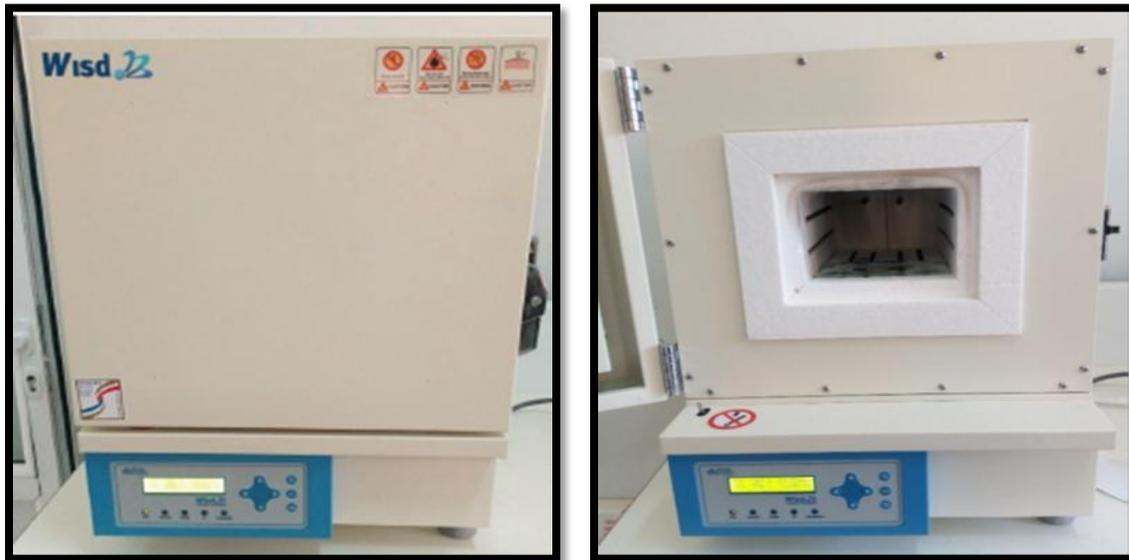
**Figure II.6** : Four à mouffle daihan scientific FH-05 digital, laboratoire de physique des couches minces et application (LPCMA), Université de Biskra.
