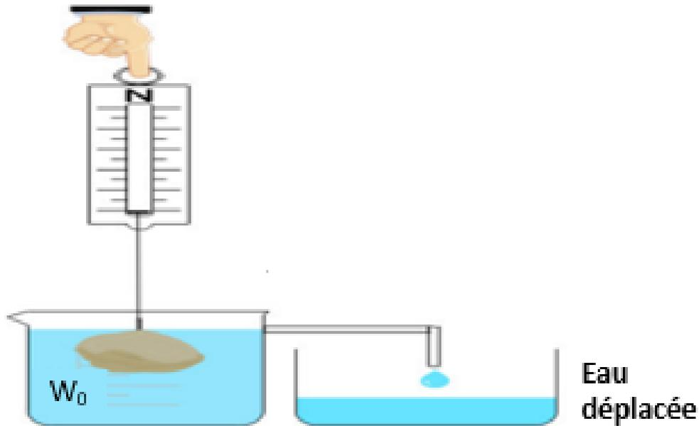
FIGURE 3.1 – Eau déplacée lorsqu'un objet est immergé dans le fluide.
