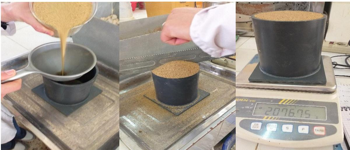
Figure 2. 5: Etapes de mesure de l'indice des vides maximum ( $e_{max}$ )
