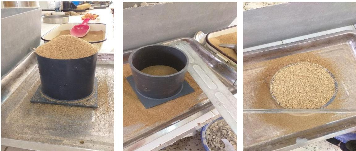
Figure 2. 4: Etapes de mesure de l'indice des vides minimum ( $e_{min}$ )
