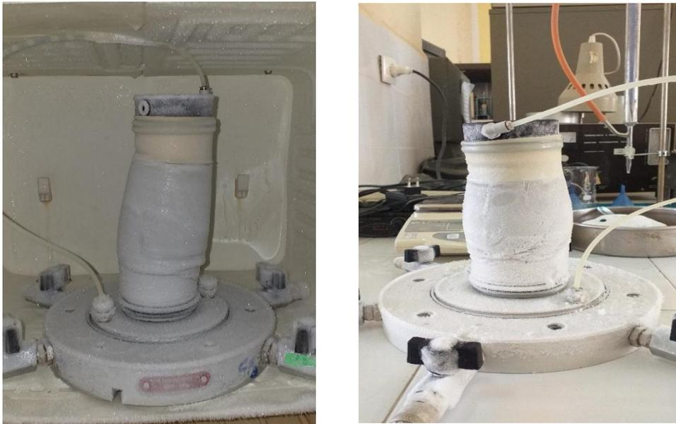
Figure 2. 10: Congélation des éprouvettes
