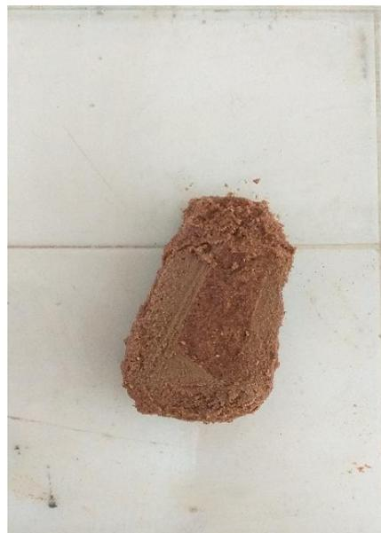
Figure 2. 13: La bande de cisaillement
