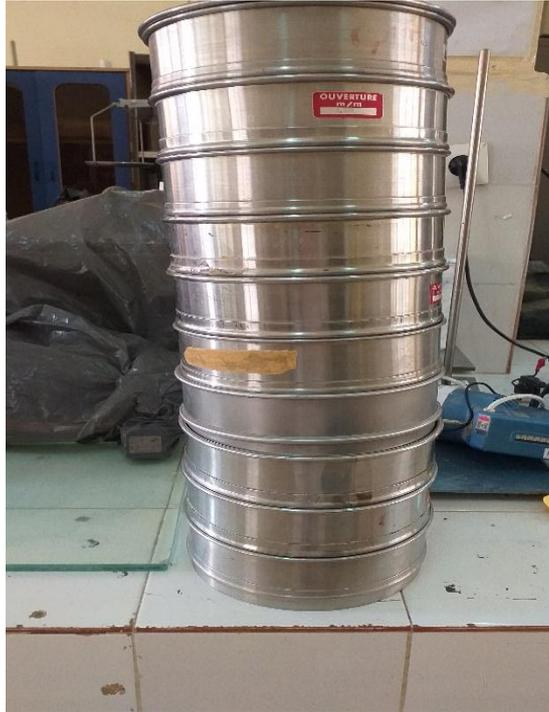
Figure 2. 2: Série des tamis utilisé pendant les essais granulométriques.
