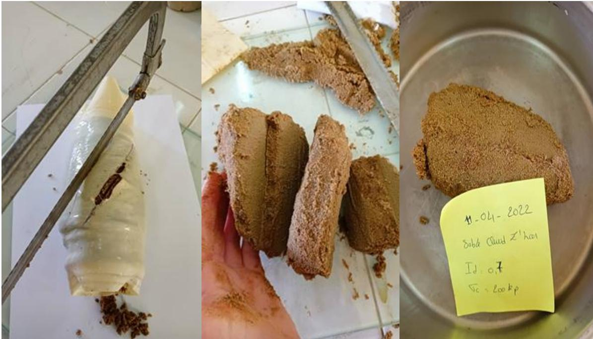
Figure 3. 8: Découpage de la bande cisaillement
