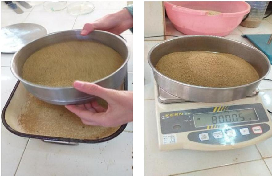
Figure 2. 3: Etapes de l'essai analyse granulométrique
