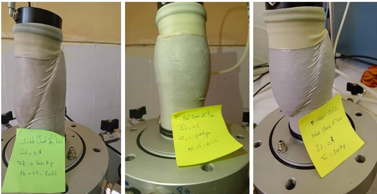
Sur cette section nous présentons un résultat de comportement mécanique d'une éprouvette de sable soumise à un chargement triaxial. Il s'agit d'une éprouvette de sable dense ayant un indice de densité de  $I_d = 0,70$  et indice des vides  $e_0$  égale à  $0,586$ . Cette éprouvette a été consolidée à une contrainte de consolidation de  $100 \text{ kPa}$ . Les résultats de ces essais sont présentés sur la Figure 3.1.
