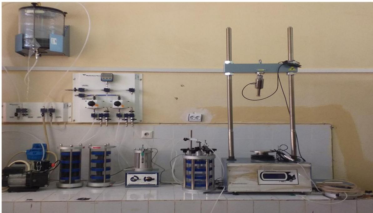
Figure 2. 7: Dispositif de cisaillement en triaxial (laboratoire de MDS de l'université de Biskra).
