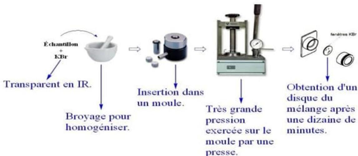
**Figure II.7:** Les différentes étapes de préparation des échantillons
