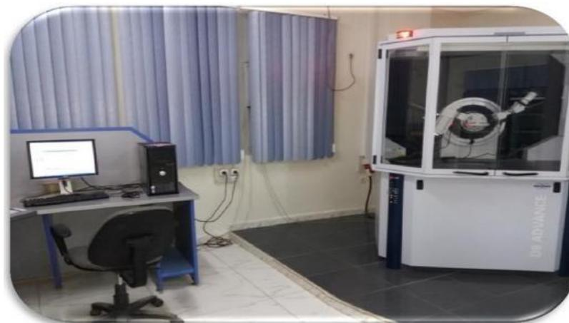
**Figure 10.** Diffractomètre des rayons X.
