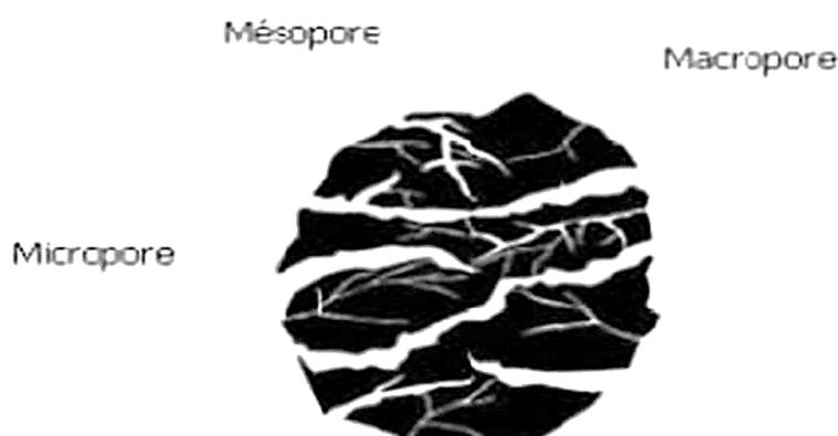
**Figure 04.** Représentation schématique des différents types de pores [16].
