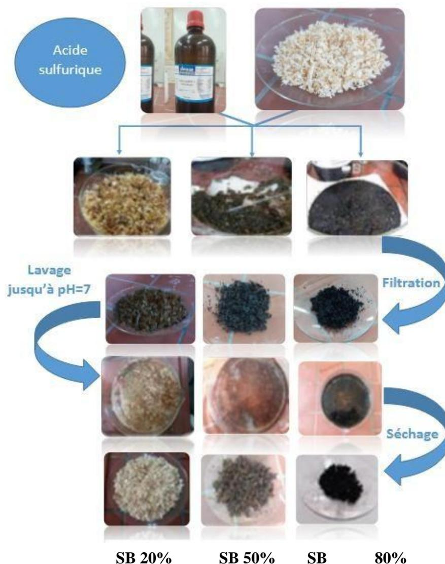
Figure 06. prétraitement à l'acide sulfurique.
