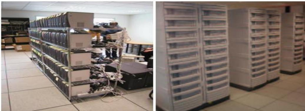
**Figure 2.4** : (A gauche) Grappe de PCs du projet iCluster (HP, INRIA, ID-IMAG) composée de 226 monoprocesseurs Pentium III à 733 MHz avec 256 Mo de mémoire, interconnectés via un réseau de 100 Mbit/s. [29]
