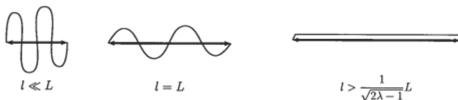
**Figure 1.3 :** Variation de l'amplitude des plis en fonction de la longueur d'une arête. [17]
