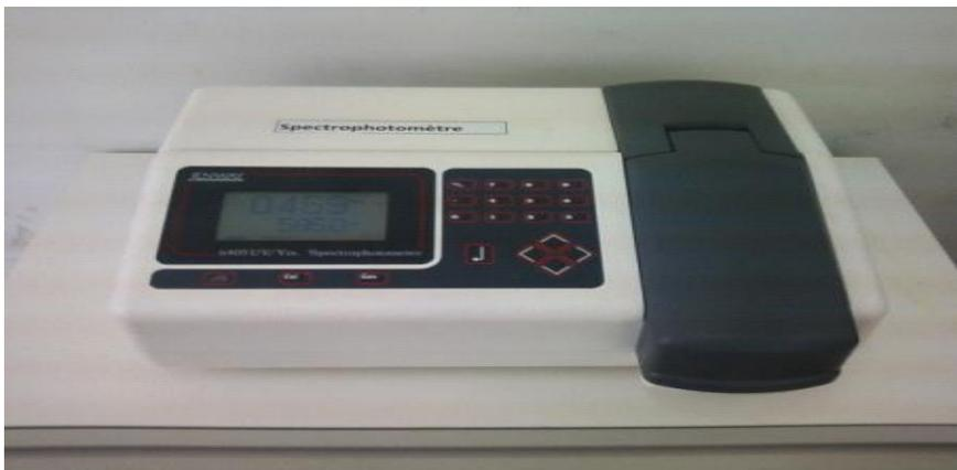
**Figure21** : lecture dans un spectrophotomètre à 490nm (ORIGINAL, 2014).
