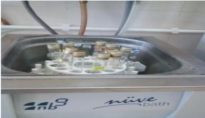
**Figure20** : Gamme étalon des sucres totaux et l'échantillon au bain marie à 30°C pendant 15 min (ORIGINAL, 2014).
