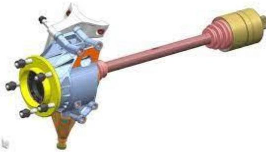
**Figure II.3. Moyeu de roue complet, montant et arbre de transmission [4].**
