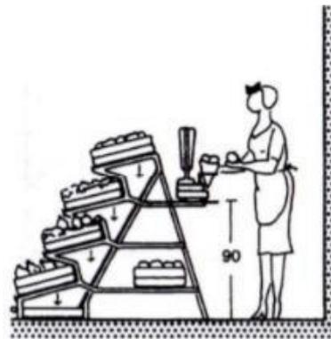
Figure 43 : Schéma fonctionnel d'un magasin de fruits et légumes (source Neufert 10eme)
