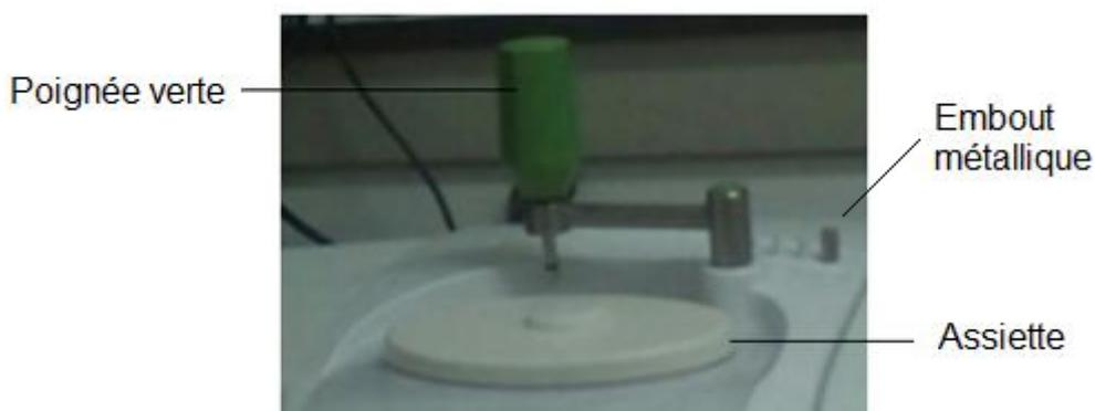
**Figure II.6 :** Mise en place de l'échantillon.
