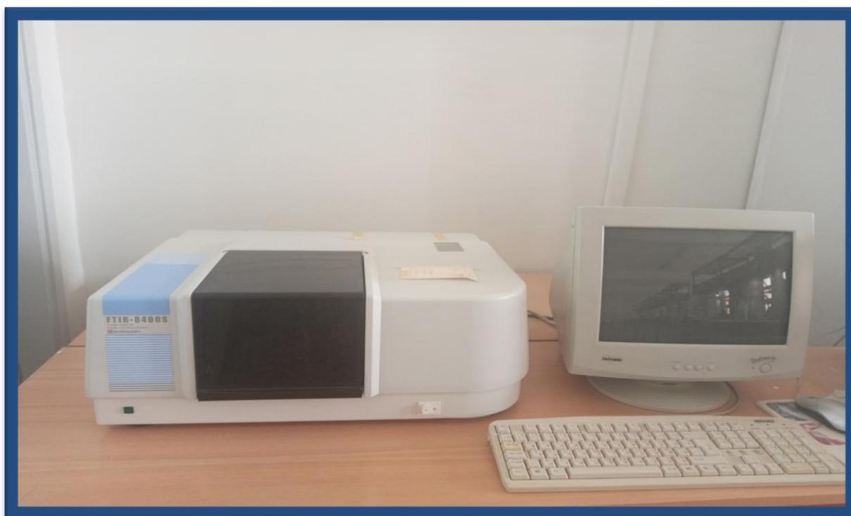
Figure II.19 Image d'un spectrophotomètre infrarouge
