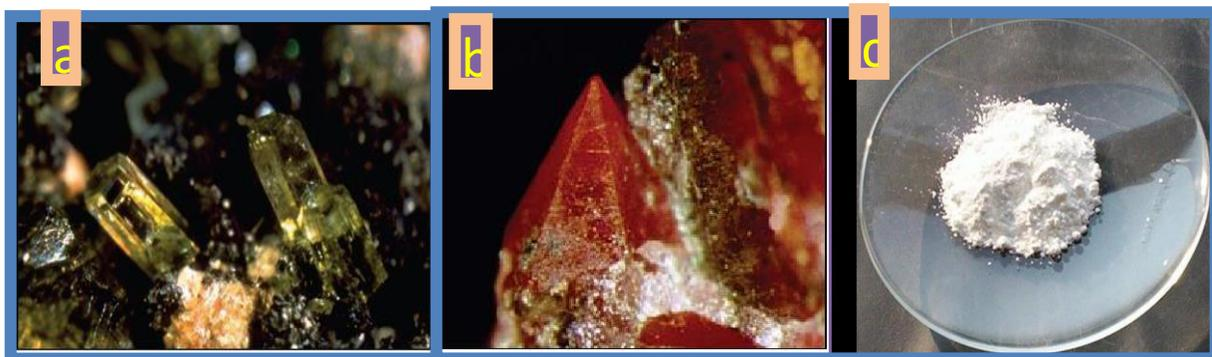
**Figure I.1 Oxyde de Zinc (ZnO) sous forme :a)naturelle, b) structures cristallines, c) poudre [1].**
