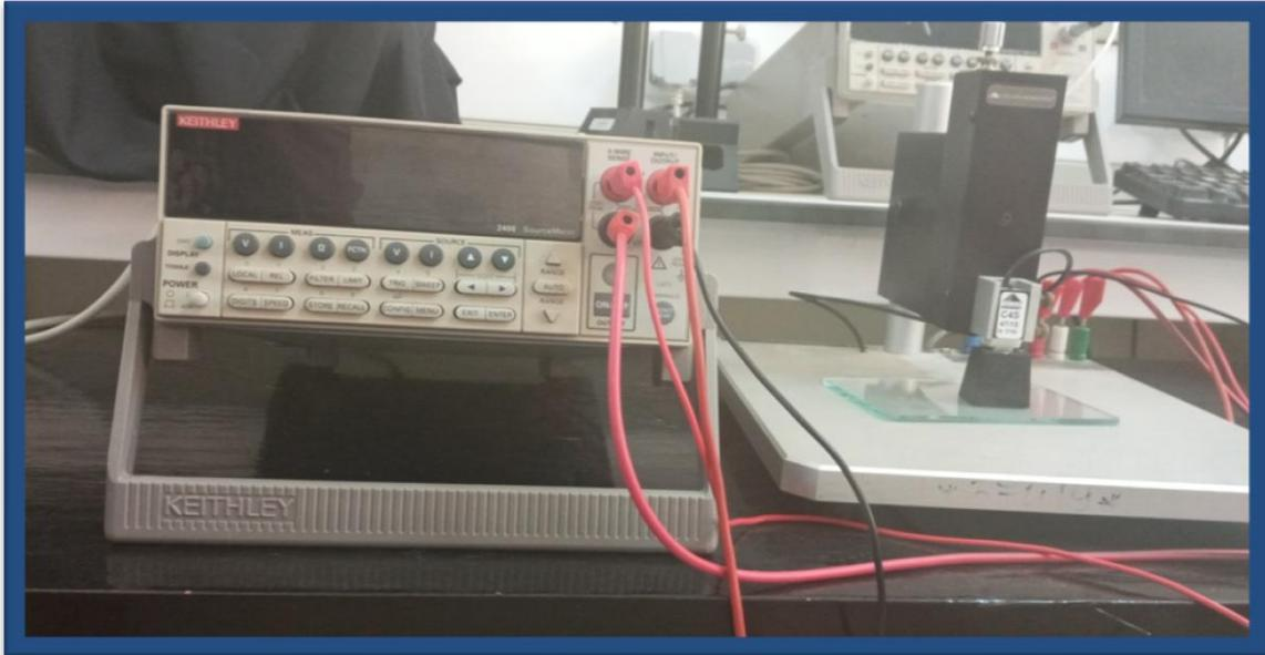
Figure II.22 Dispositif électronique de la méthode de quatre pointes
