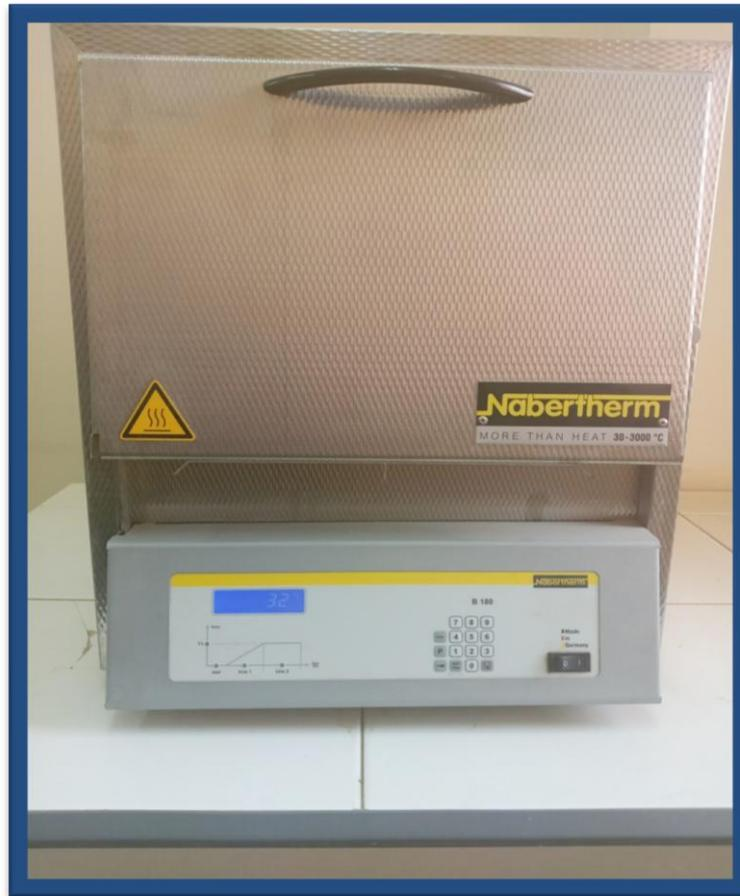
Figure II.10 Le four utilisé pour la calcination
