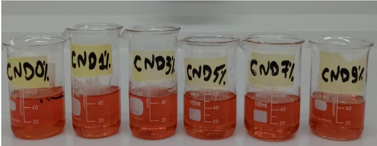
**Figure.II.2 :** Solutions préparées de chlorure de Cobalt à différent taux de Nickel
