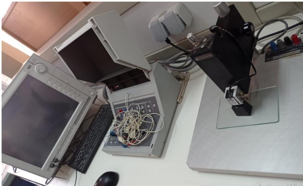
Figure II.17 : Montage expérimental de système de quatre points
