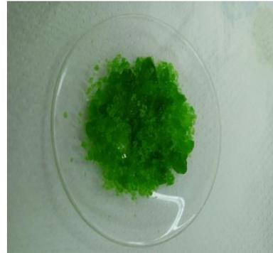
**Figure.II.4** : Chlorure de Nickel Hexa hydrate**II.2.4. Conditions expérimentales**
