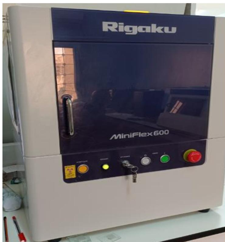
Figure II.8 : diffractomètre de rayons X Rigaku-Type MiniFle 600 (LPCMA Univ-Biskra)
