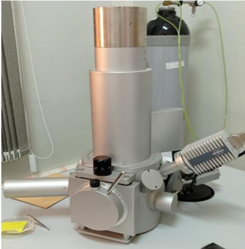
**Figure II.15 :** Microscope Électronique à Balayage de type TESCAN VEGA
