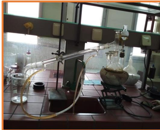
**Figure III.3 : Montage d'hydrodistillation**
