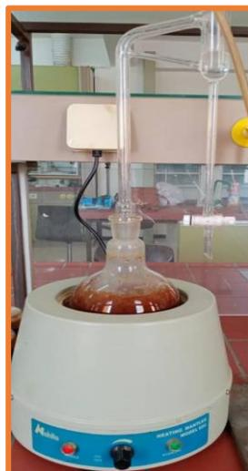
**Figure III.4 : Montage hydrodistillation par clvenger**
