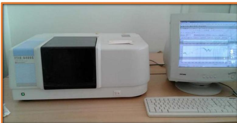
**Figure III.24 : Appareillage spectroscopie infrarouge**
