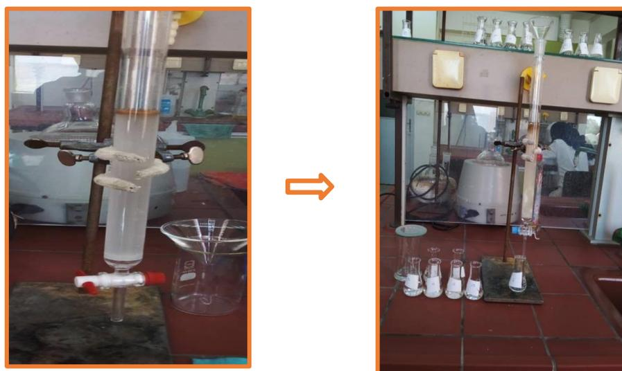
**Figure III.16 : Processus de séparation par la chromatographie sur colonne**
