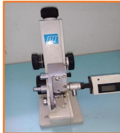
**Figure III. 9 : Réfractomètre**
