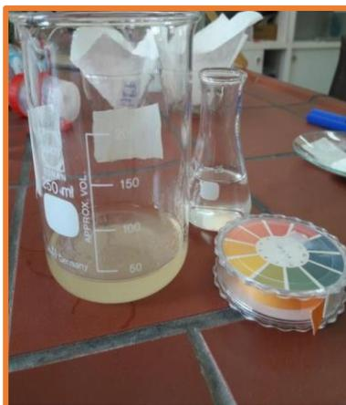
**Figure III.20 : Test PH de la phase aqueuse**
