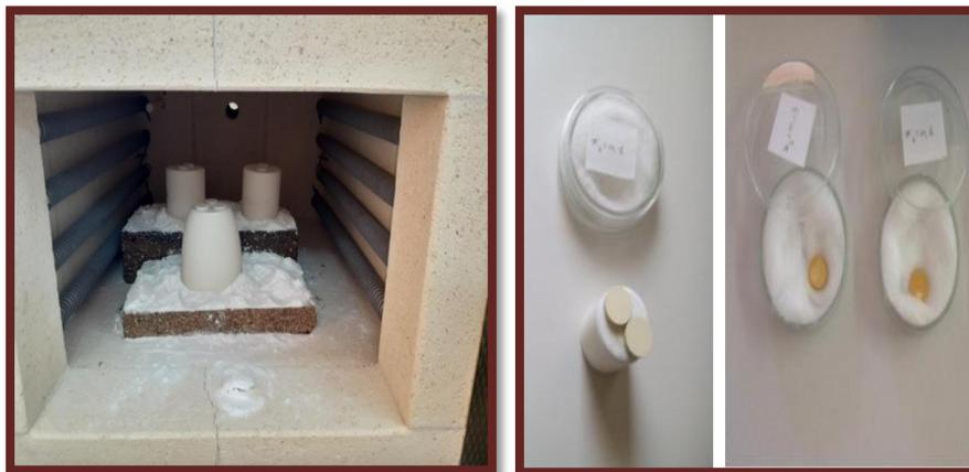
**Figure III.23** : L'échantillon avant et après le frittage.
