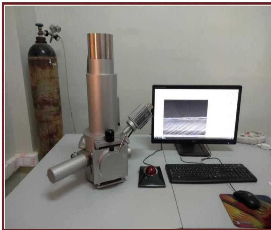
**Figure II.17** : Le microscope électronique à balayage de type TESCAN (VEG A3).
