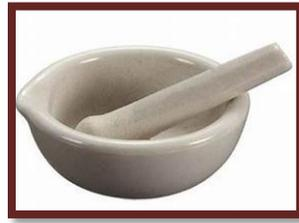
Figure II.8 : Mortier utilisé pour le broyage.
