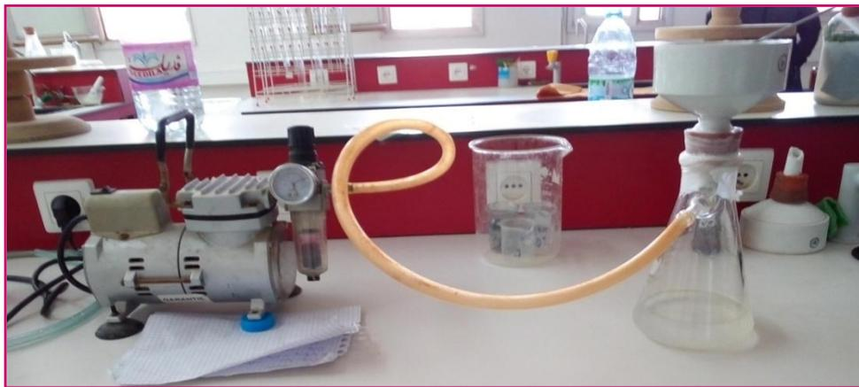
**Figure III. 5** : La filtration sous vide du précipité.
