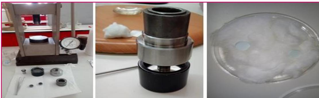
**Figure III.13** : préparation des pastilles pour la mesure de densité.
