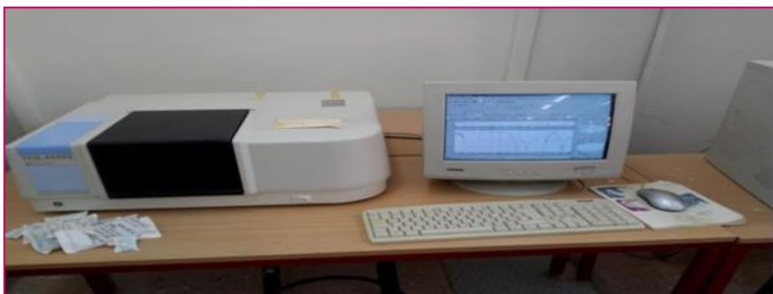
**Figure III. 15** : L'appareil est de mark **SHIMADZU FTIR-8400S PC**.
