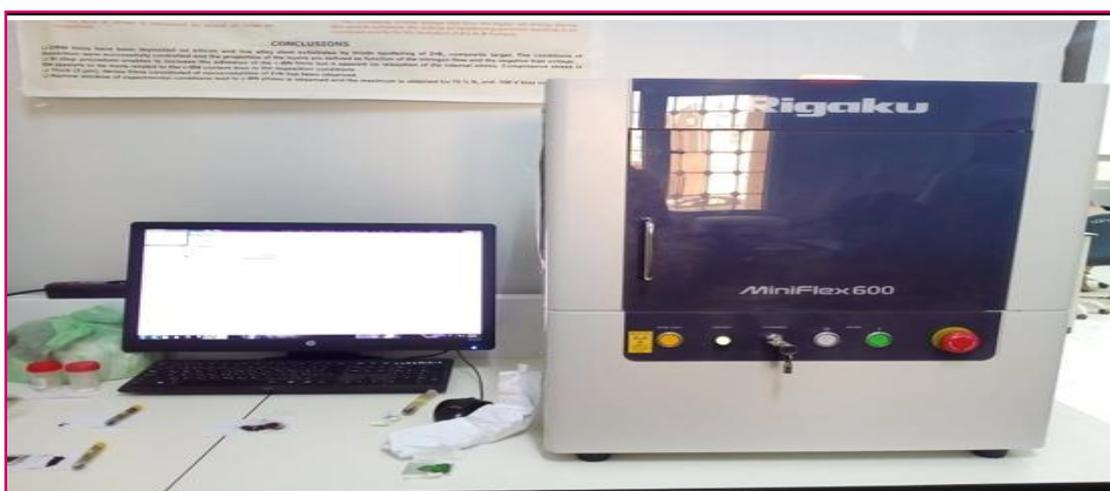
Figure III. 17 : L'appareil mark RIGAKU MINIFLEX 600.
