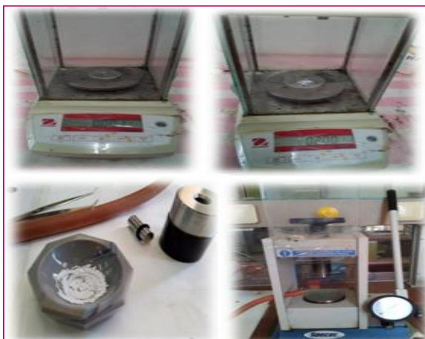
**Figure III.14** : Préparation de pastille pour analyser par infrarouge.
