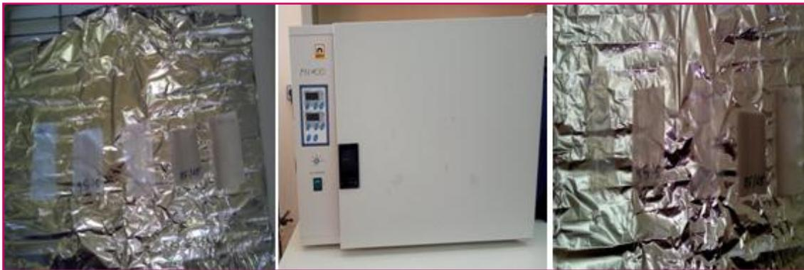
**Figure III.18** : Les plaques avant et après traitement thermique.
