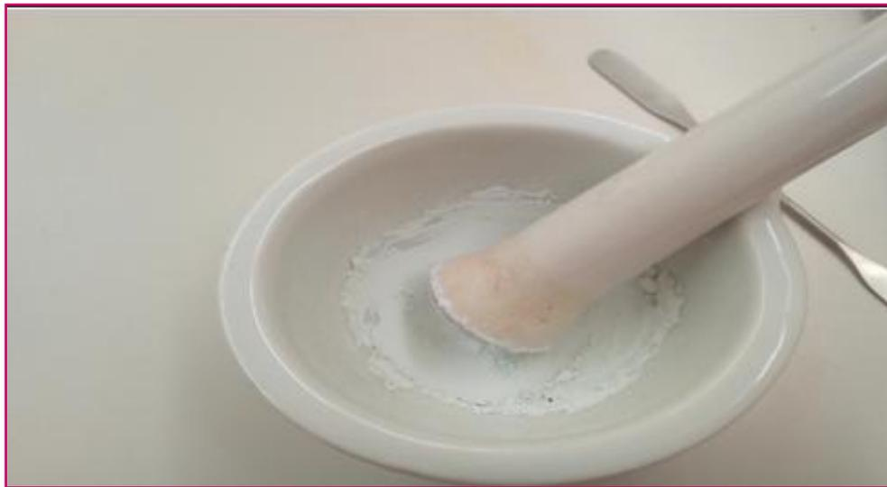
**Figure III. 8** : Rebroyage de l'hydrpxyapatite.
