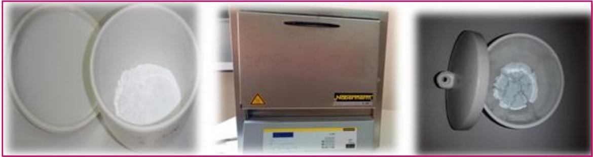
**Figure III. 7** : Calcination du produit obtenu.
