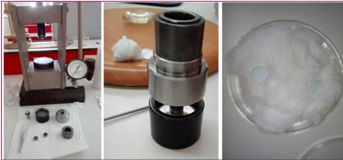
**Figure III.9** : Préparation des pastilles de poudre obtenue.
