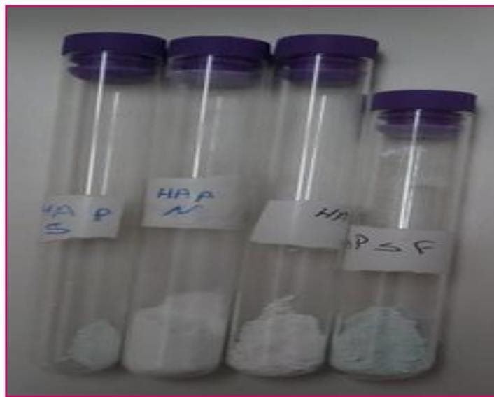
Figure III. 16 : les échantillons pour DRX.
