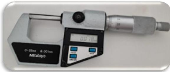
**Figure II.10 :** Micromètre palmer avec afficheur numérique 0-25 mm
