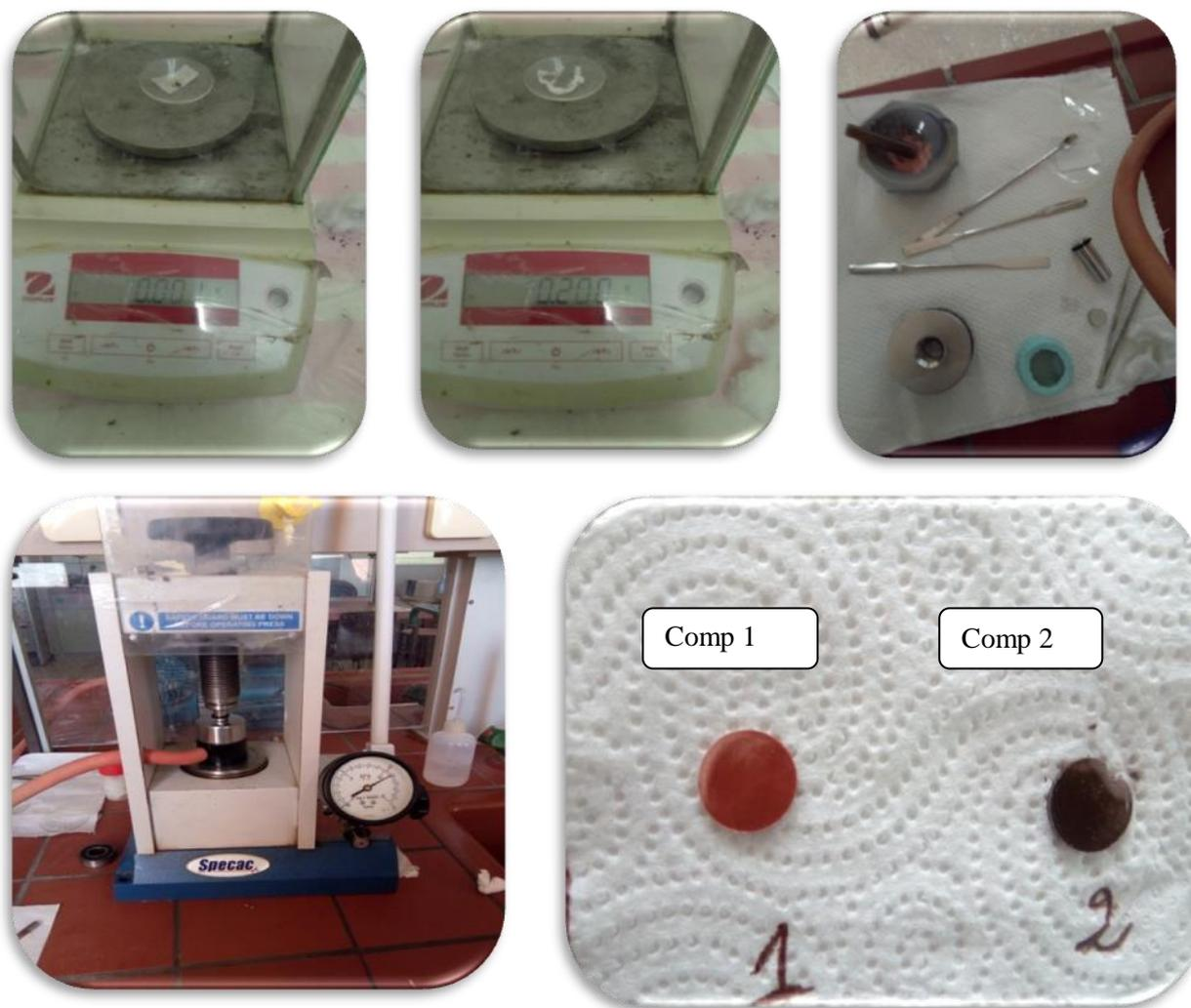
Figure II.15 : La préparation des échantillons avec Mortier en agate et presse hydraulique.
