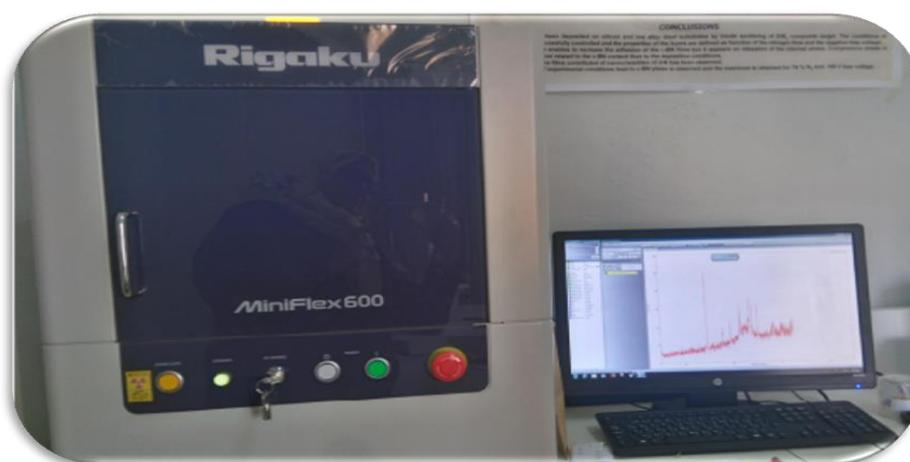
**Figure II.6:** Diffractomètre Miniflex 600 en configuration Bragg/Brentano dite ( $\theta$ - $\theta$ ).
