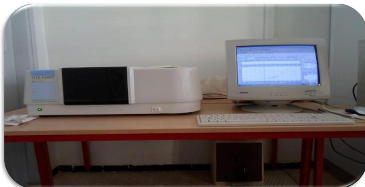
Figure II.16 : Spectromètre infrarouge à transformée de Fourier FTIR- Shimadzu FTIR-8400.
