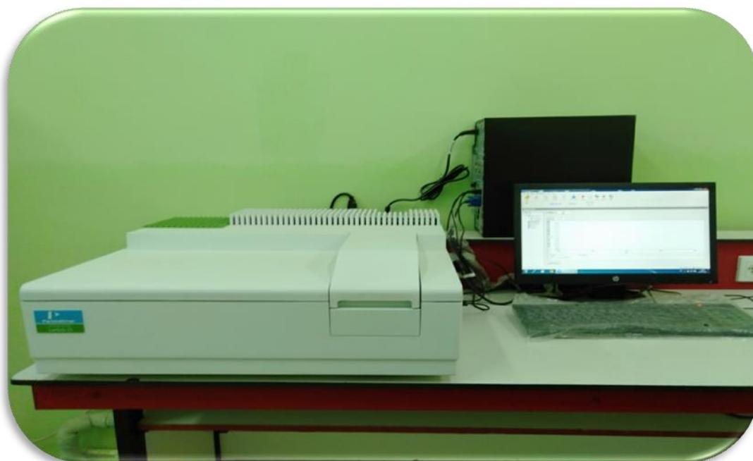
*Figure II.19: Spectromètre UV-visible de type "PerkinElmer UV Lambda 25".*
