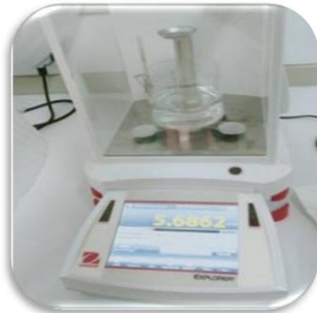
**Figure II.11 :** Balance électrique couplée à l'instrument basé sur la technique de poussée d'Archimède.
