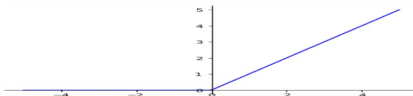
Figure 3.5: Un graph de l'application de la fonction d'activation Relu.
