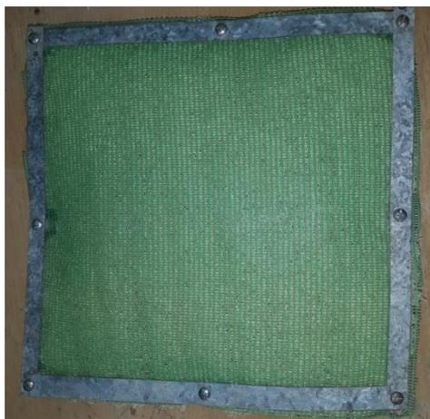
**Figure (III.5) :** Pad en fibres de luffa recouvertes d'une toile en plastique perforée
