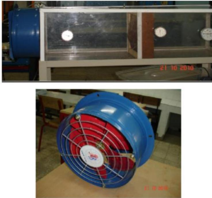
**Figure (I.6) :** Banc d'essai expérimental avec ventilateur de soufflage de l'air.[7]
