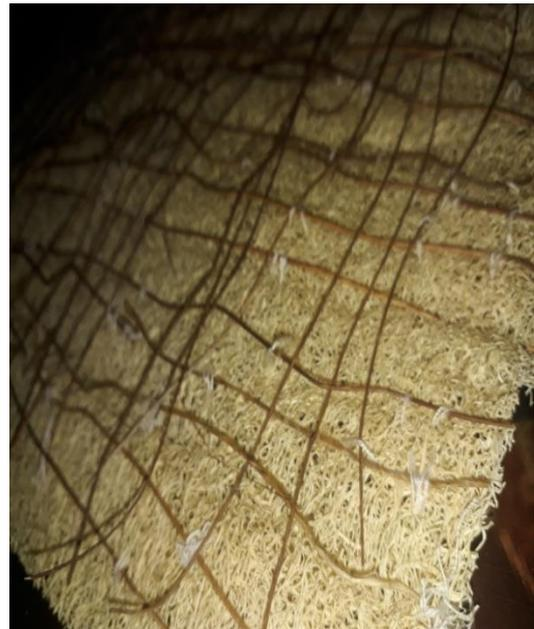
**Figure (III.8) :** pad de luffa avec fibres de palmier dattier fixées verticalement et horizontalement
