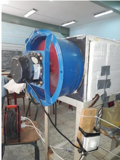
**Figure (III.2) :** Ventilateur d'air réglable dont le débit est ajusté avec un potentiomètre
