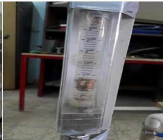
**Figure (III.12) :** Débitmètre à flotteur muni d'une vanne d'alimentation pour ajuster le débit
