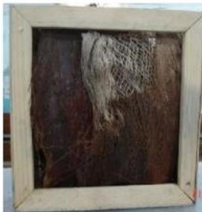
**Figure(I.7) :** Enceinte d'humidification en bois contenant des fibres végétales de palmier dattiers local.[7]
