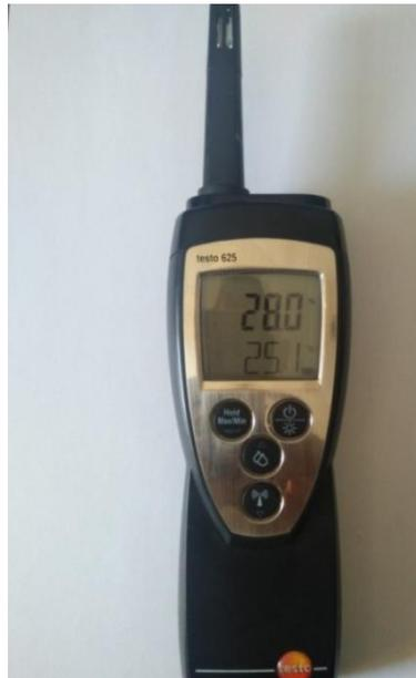
Figure (III.15) : Hygromètre de type Testo 625.
