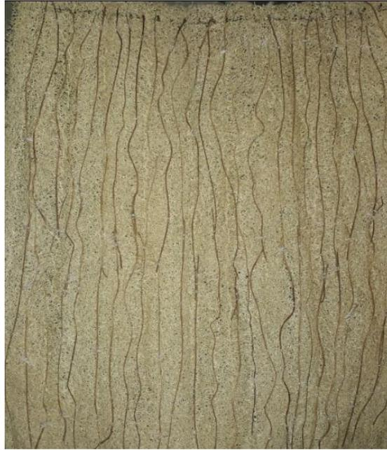
**Figure (III.7) :** pad de luffa avec fibres de palmier de palmier dattier fixées verticalement
