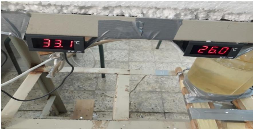
Figure (III.16) : Capteurs de température avec afficheurs électroniques
