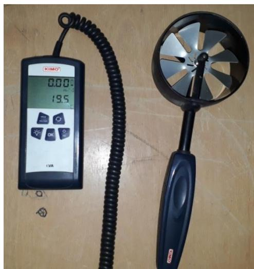
**Figure (III.14) :** Anémomètre à hélice de type KIMO LV 110
