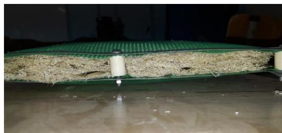
**Figure (III.6) :** Pad constitué de fibres de luffa
