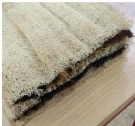
**Figure(I.19) :** Couches hybride constituées de fibres de luffa et de palmier dattier [3]
