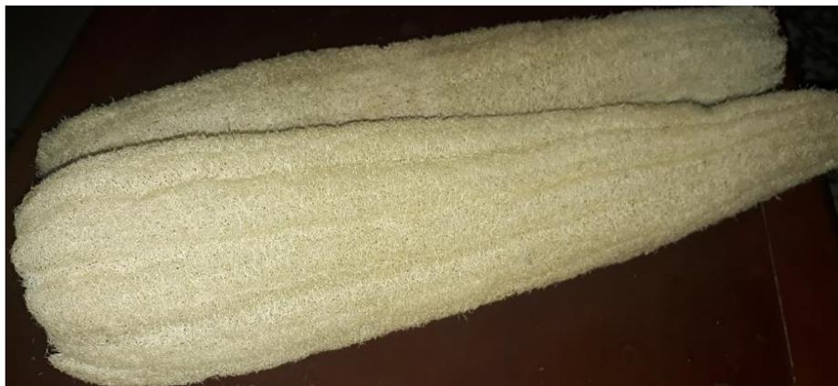
**Figure (III.3):** Photographie du matériau végétal fibreux « le Luffa » utilisé comme interface humide dans le procédé de rafraîchissement d'air.
