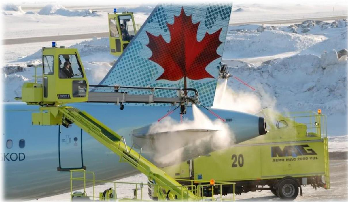
Figure I. 13 : Dégivrage au sol par jet impactant [28].
