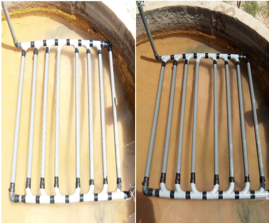
**Photo 6 :** Echangeur à 8 tubes (Expérience de refroidissement).
