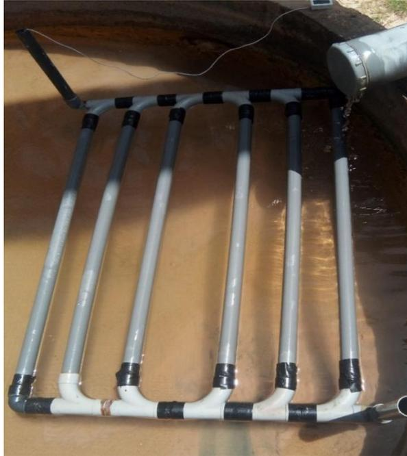
**Photo 5** : Échangeur à 6 tubes (expérience de refroidissement)
