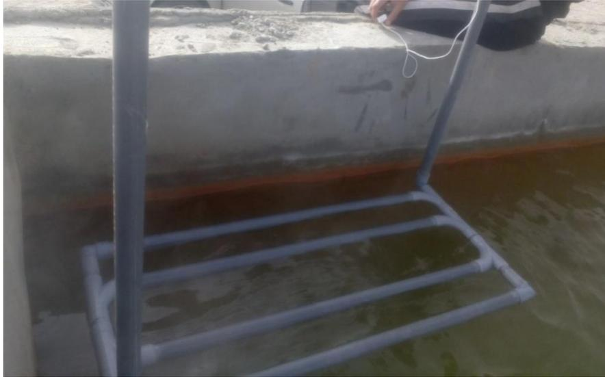
**Photo 1** : Echangeur à 4 tubes (Expérience de chauffage).
