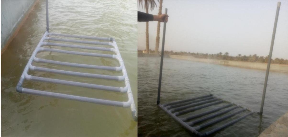
**Photo 3:**Échangeur à 8 tubes (Expérience de chauffage).
