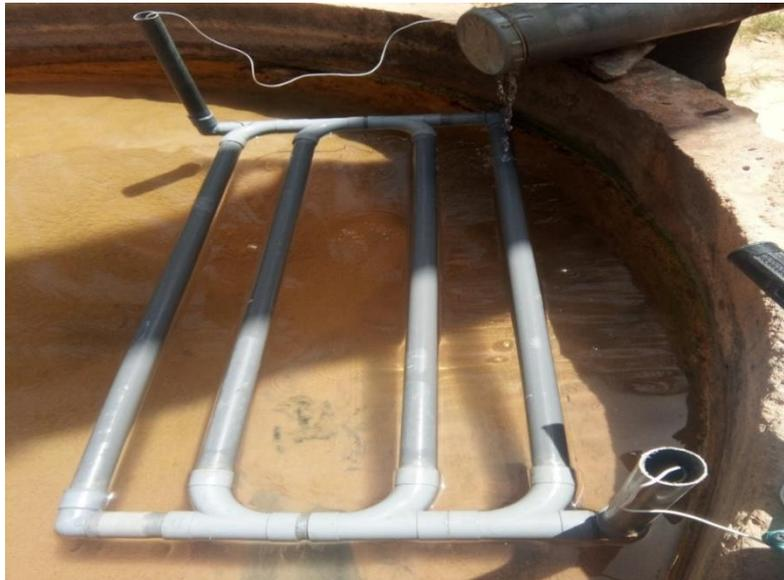
**Photo 4** : Echangeur à 4 tubes (Expérience de refroidissement).
