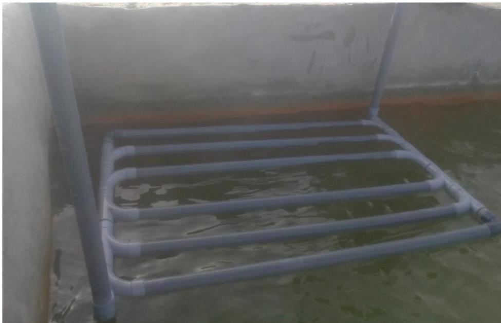
**Photo 2** : Echangeur à 6 tubes (Expérience de chauffage).
