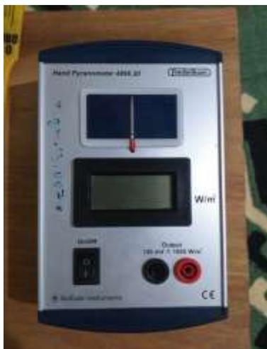
**Figure. IV.1 :** Photo d'un Pyranomètre digital utilisé.
