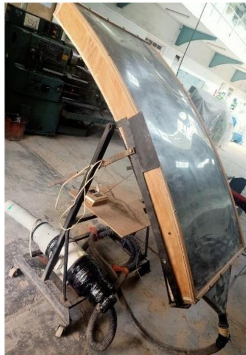
**Figure (b) :** Vue de profil du capteur curviligne
