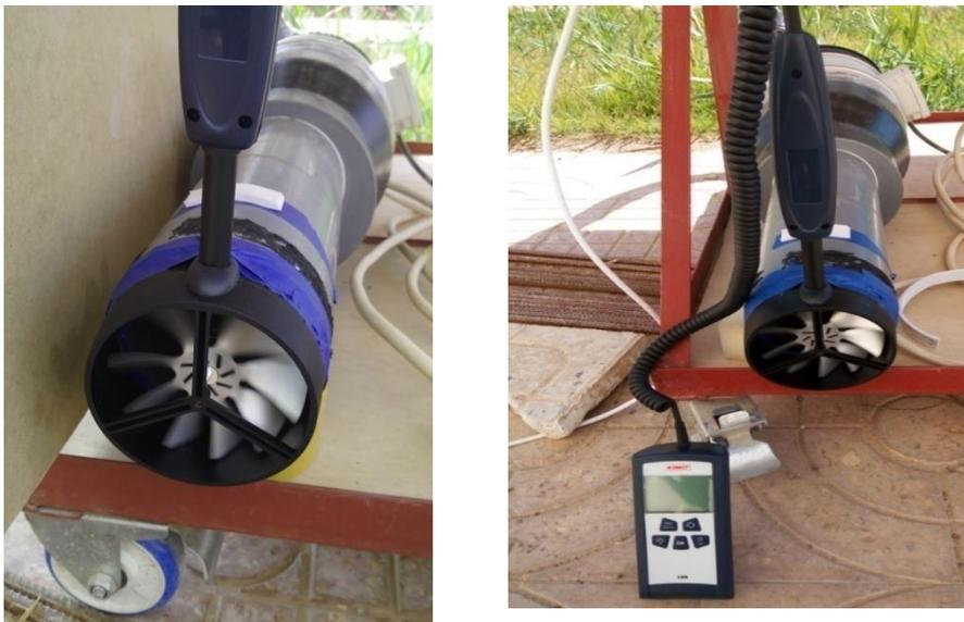
**Figure .3.2** :Thermo-anémomètre à hélice de type KIMO LV 110 pour mesurer le débit et la vitesse de l'air au niveau du conduit de récupération de la pompe à air.
