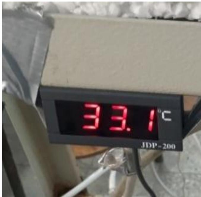
**Figure .3.3 :** Thermomètres digital JDP-200 avec panneau afficheur.
