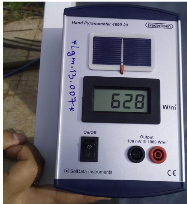
Figure .3.4: Pyranomètre manuel.
