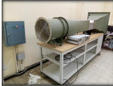
**Figure 3.10:** Wind Tunnel SIEMENS 2CQ5400-1DB01-1BG2:
