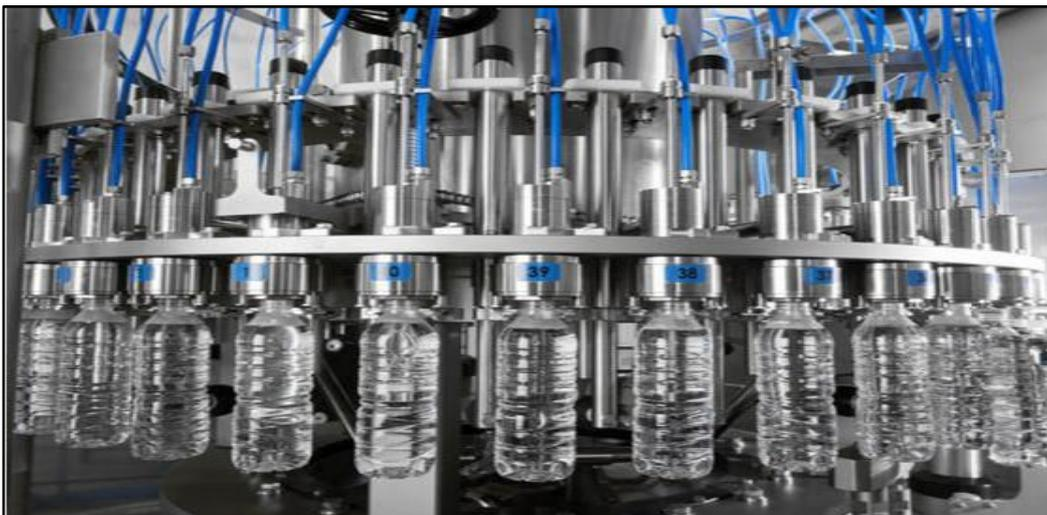
**Fig II.12 :** Remplisseuse de bouteilles.
