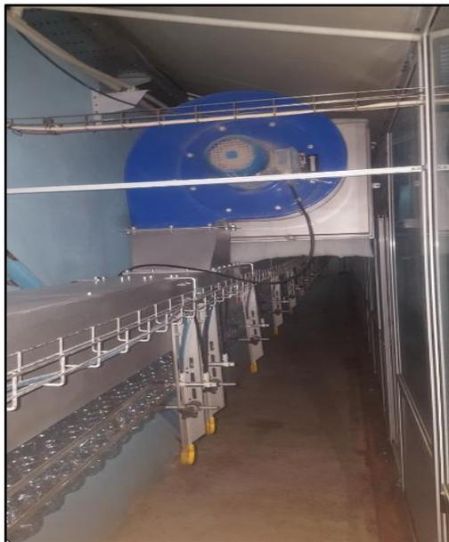
**Fig II.10** : Convoyeur aérien de bouteilles.
