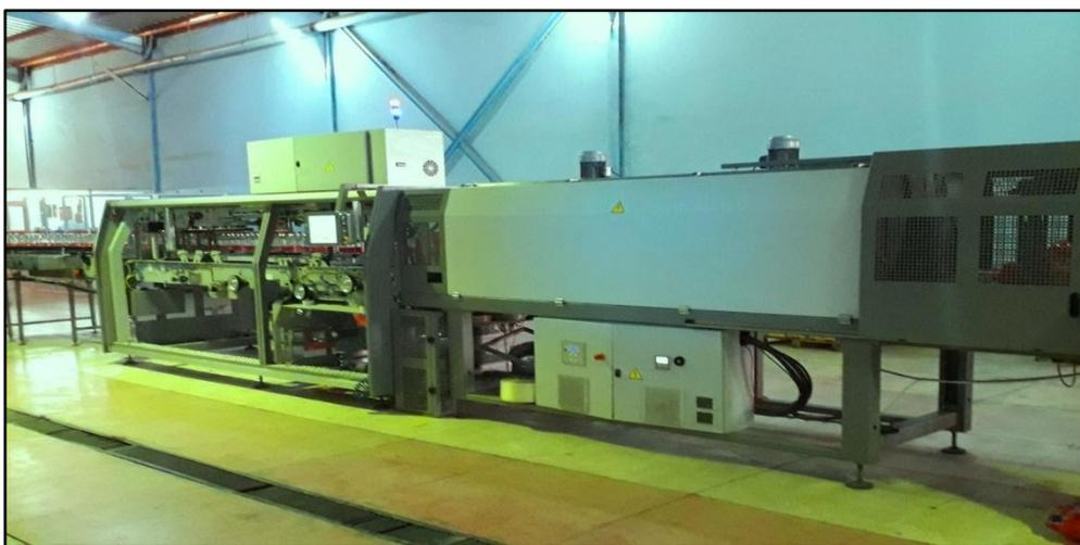
**Fig II.16 :** Fardeleuse de bouteilles PET
