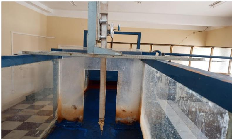
**Figure 3.6** : Photographie du déversoir rectangulaire sans hauteur de pelle avec contraction latérale ayant servi à la mesure du débit.
