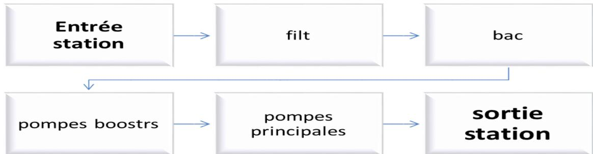
**Figure 10: Description générale de fonctionnement de la station**
