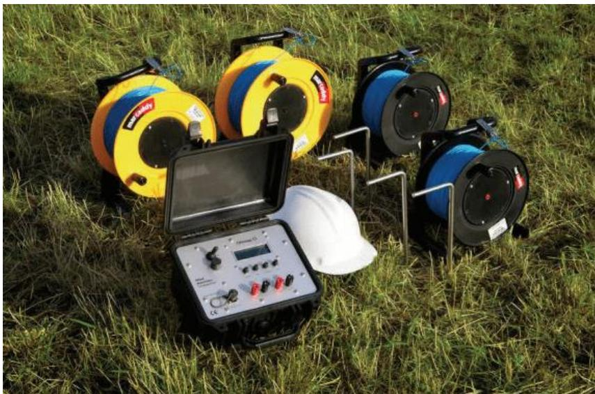
Figure II.1 : Ohmega-Résistivimètre
