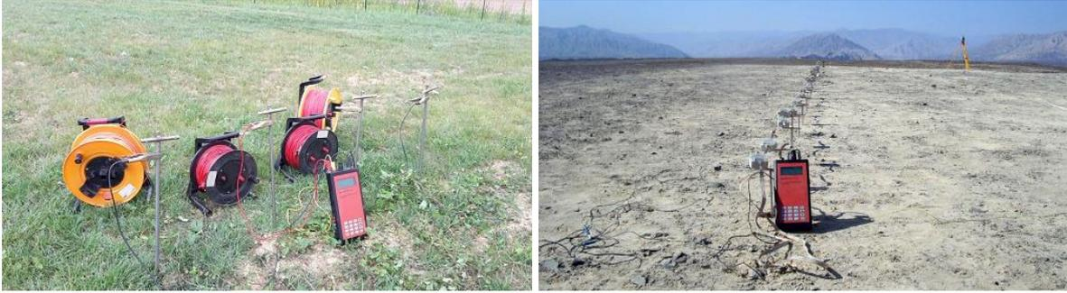
Figure II.4 : Résistivimètre 4POINT LIGHT 10W
