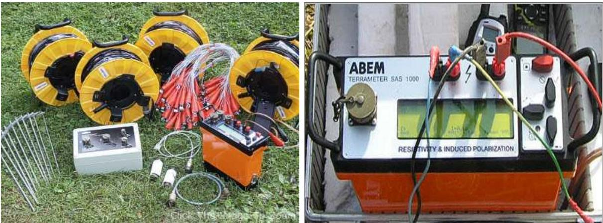
Figure II.3 : Résistivimètre TERRAMETER SAS1000
