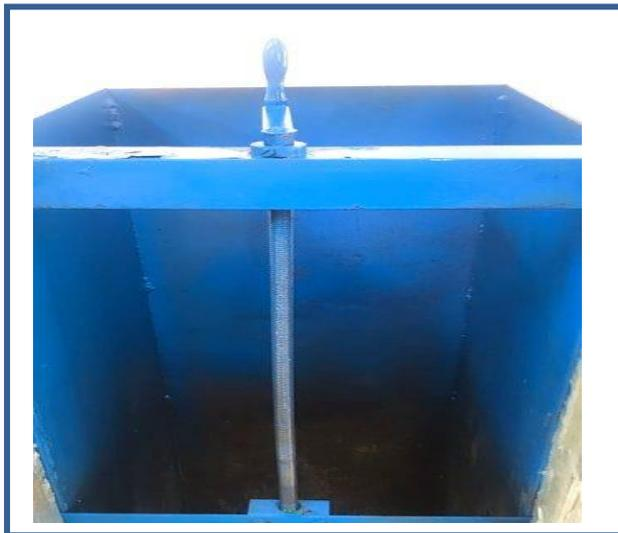
**Figure 1.10:** photographie de la vanne en aval en aval
