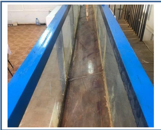
**Figure 1.14:** Photographie du modèle expérimental du canal en aval.
