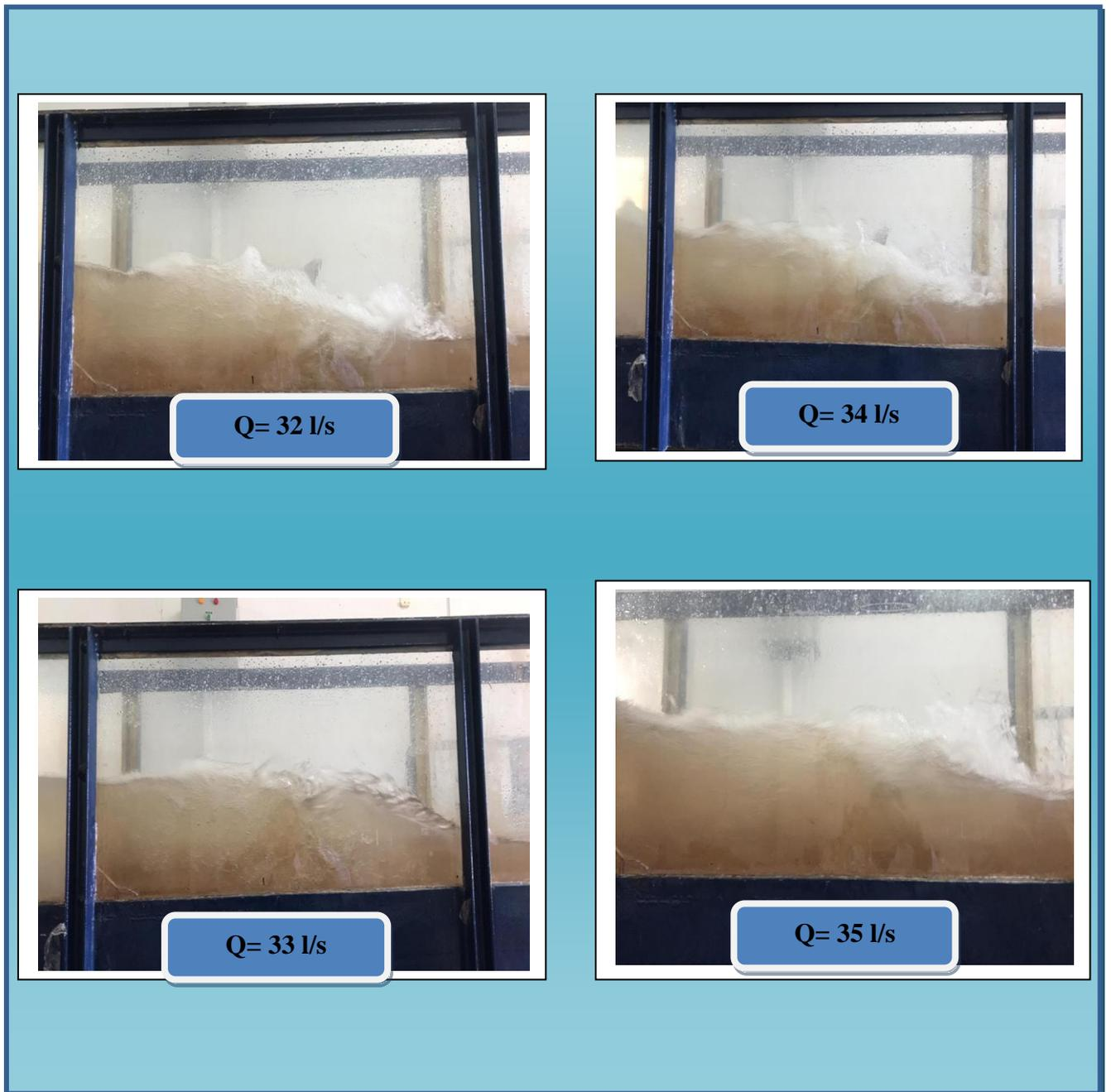
**Figure 2.5 :** Ressaut hydraulique évaluant dans un canal non-rectangulaire «ouverture 9.5 cm»
