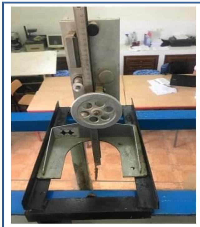
**Figure 1.20:** photographie de l'limnimètre
